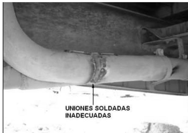
Fotografía 04: Defectos de soldadura del tubo de escape
