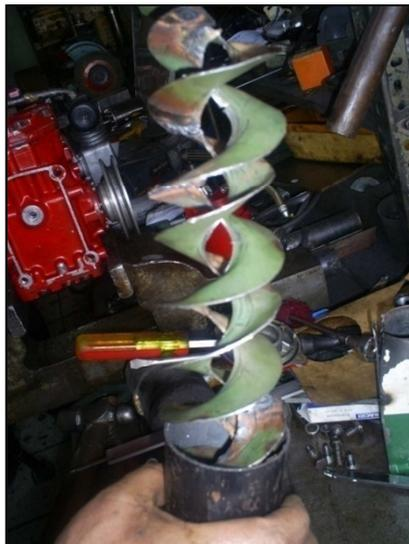
Fotografía 23. Encaje de las aletas en el tubo exterior
