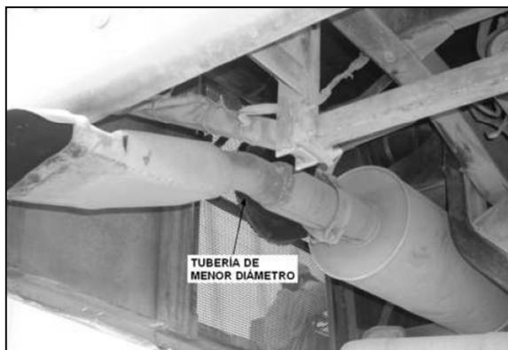
Fotografía 01: Cambio de sección del tubo de escape
