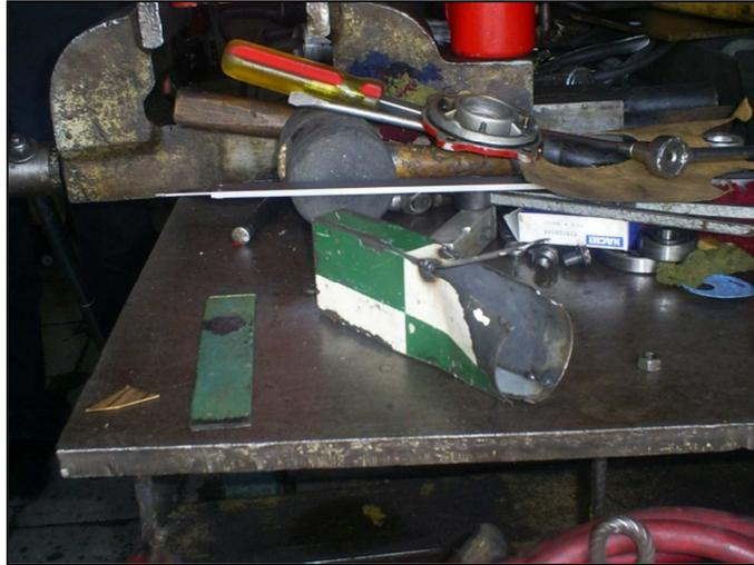
Fotografía 24. Trazo del tubo de sección cuadrado-circular
