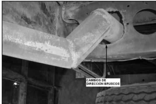
Fotografía 02: Cambios de dirección del tubo de escape
