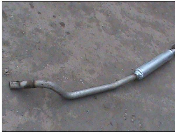
Fotografía 15. Ensamble final del tubo de escape
