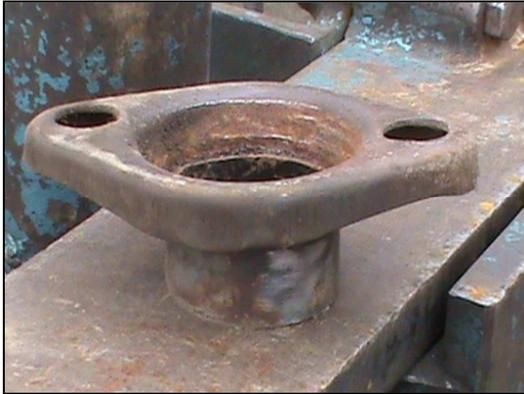
Fotografía 07. Brida para la conexión del tubo de escape con el múltiple
