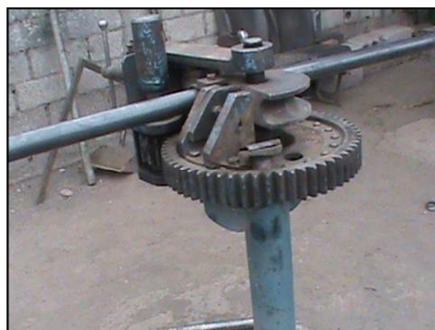
Fotografía 14. Doblado de partes curvas del tubo de escape
