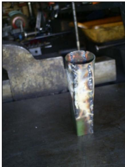
Fotografía 25. Construcción del tubo de sección cuadrado-circular
