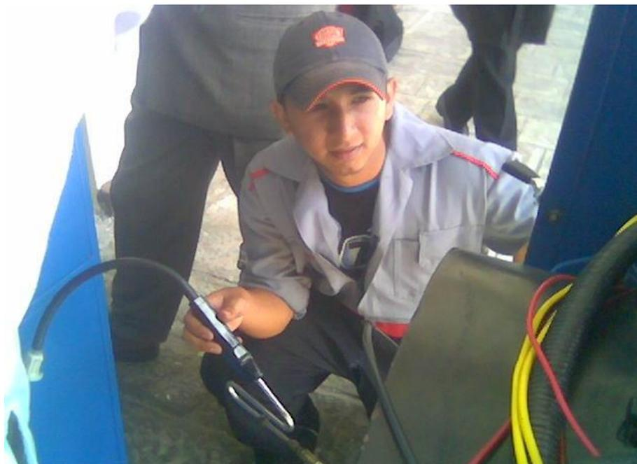
**Figura 5.6. Ingreso de la sonda en el escape**
