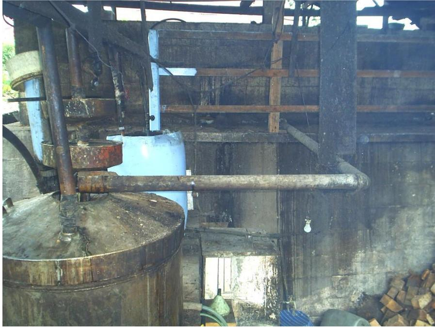
**Figura 2.8. Precalentamiento del jugo fermentado**
