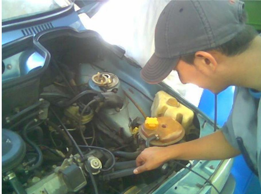
**Figura 5.5. Conexión del captador de voltaje**
