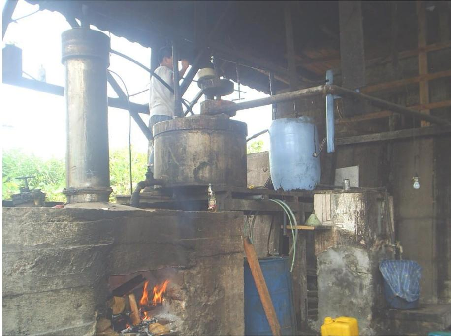
**Figura 2.11. Conjunto de elementos para la obtención del etanol**
