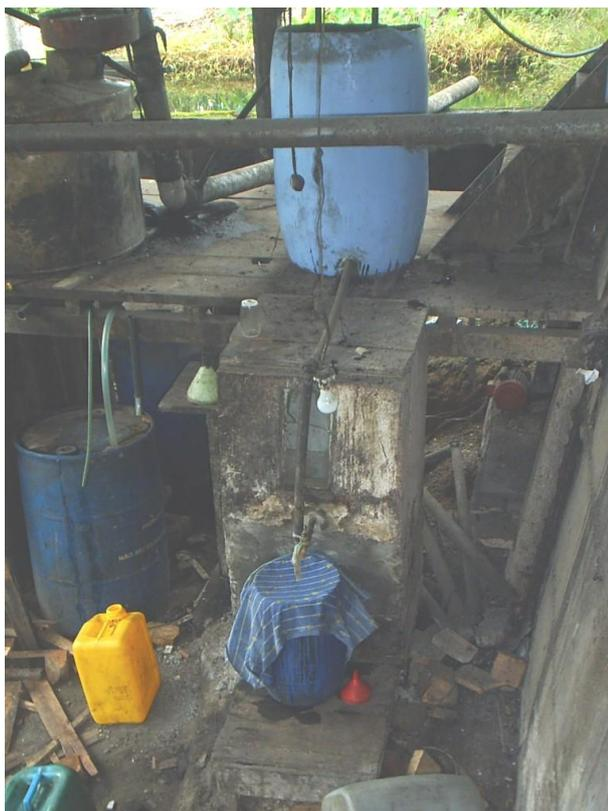
**Figura 2.10. Tanque con agua donde se coloca el serpentín y recipiente de recolección del etanol**
