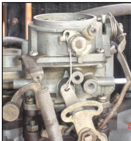
Figura 3.33. Mecanismo para el ajuste de ralentí.
