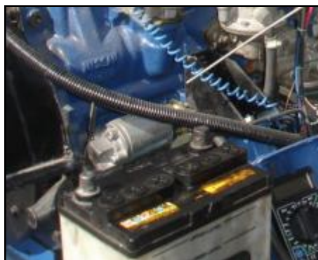
Figura 3.38 Desconexión de bornes
