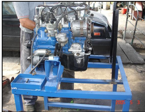
Figura 2.1. Estructura metálica para el módulo de pruebas.
