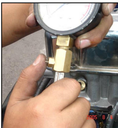
Figura 3.19 Toma de dato y purga de presión
