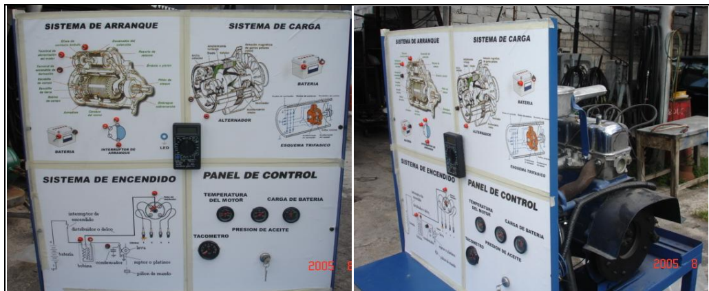
Figura 3.2. Panel de conexiones Nissan A12.
