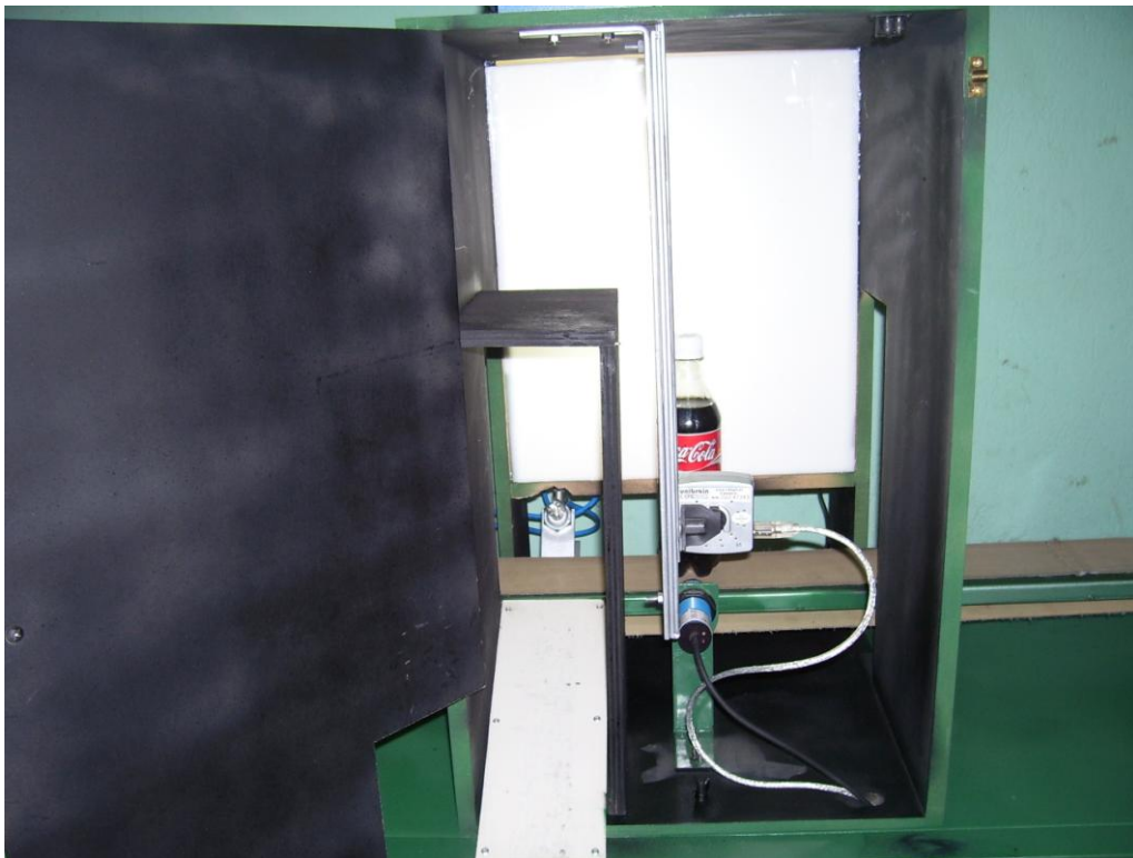
Figura 3.1 Armario de iluminación
