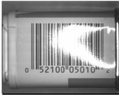
Figura 2.16.b Superficie que refleja luz al ángulo de incidencia
