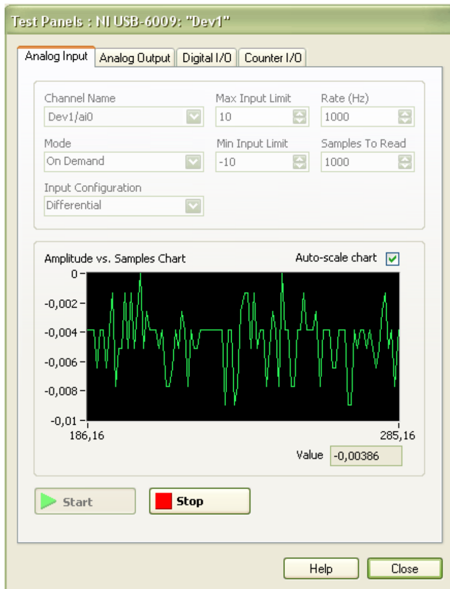
Figura C5 Trazado de entradas análogas
