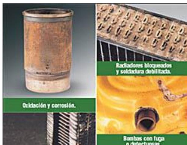
Si ponemos mayor atención a lo que ocurre en los cilindros, veremos que cualquier incremento de temperatura por encima del valor de diseño, provocará una disminución de la viscosidad de la película de lubricante sobre las paredes del cilindro, provocando el roce de metales con el consiguiente desgaste de las piezas. Este daño es de tipo irreversible, ya que si de manera inmediata mejoramos el enfriamiento, el desgaste producido no se podrá solucionar.
