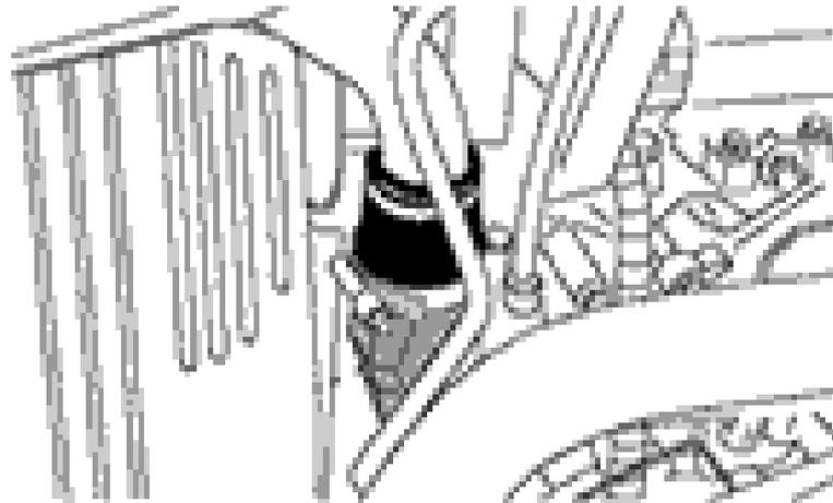
La forma recomendada para agregar refrigerante al sistema de enfriamiento del motor es a través del tanque de recuperación, removiendo el tapón “A”.
