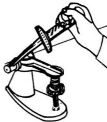
Fig. 3.23 Medición de la presión del resorte
