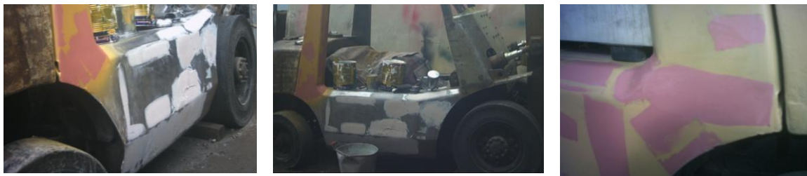
Fig. 6.8 Aplicación de las masillas
