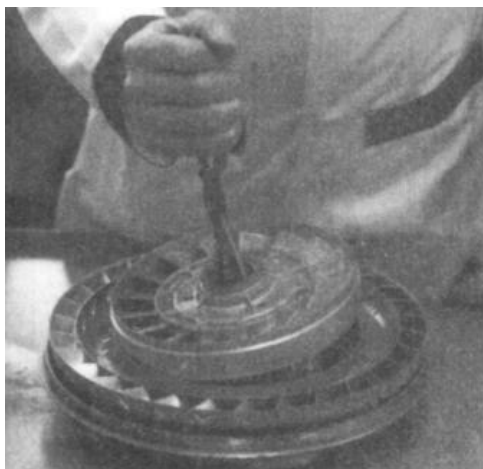
Fig. 4.9 Extracción del estator
