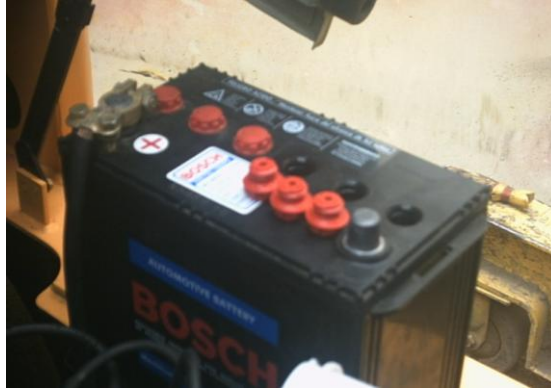
Fig. 7.9 Inspección del electrolito de la batería
