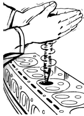
Fig. 3.21 Asentado de las válvulas
