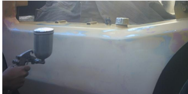
Fig. 6.7 Aplicación de la base - fondo
