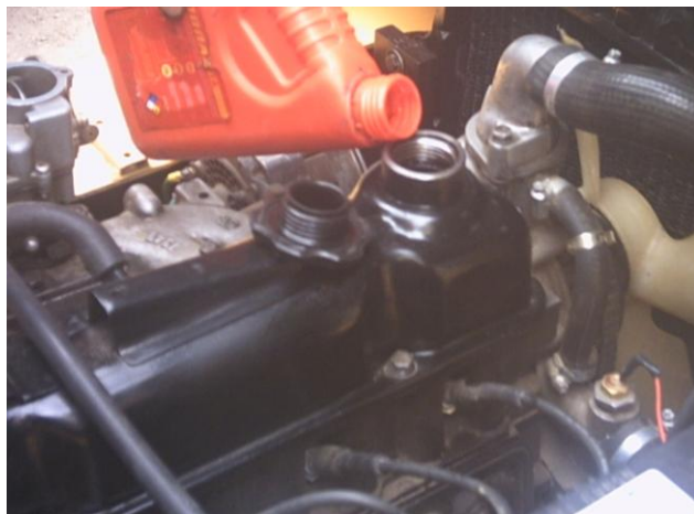
Fig. 7.2 Adición de aceite del motor
