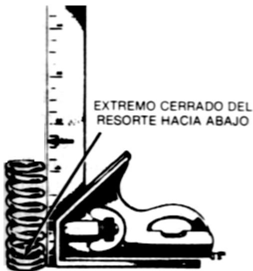
Fig. 3.22 Revisión de los resortes de las válvulas
