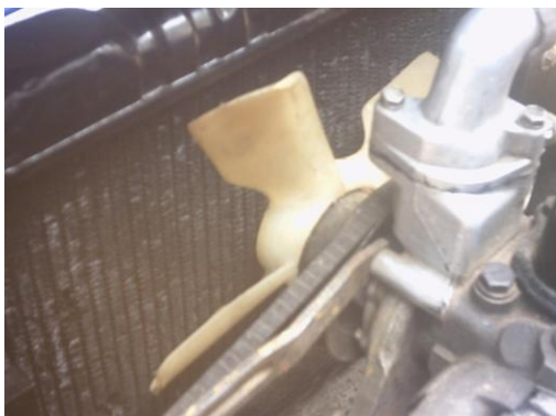
Fig. 7.8 Inspección de la correa del ventilador
