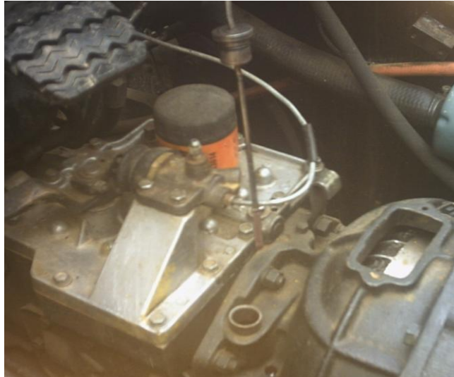
Fig. 7.10 Inspección del aceite del convertidor de par
