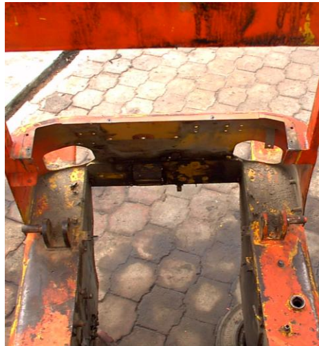
Fig. 6.3 Desprendimiento y oxidación de la pintura
