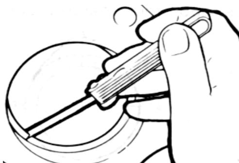
Fig. 3.38 Verificación del entrehierro entre extremos de los anillos de los pistones
