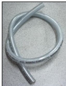
Figura 3.9. Manguera de Presión con nylon usada en la aplicación
