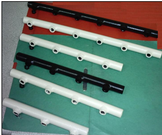
Figura 3.16. Diseño final de los rieles de inyectores.
