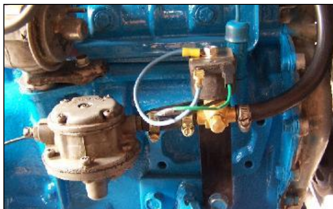
Figura. 4.6 Montaje de la electroválvula de gasolina
