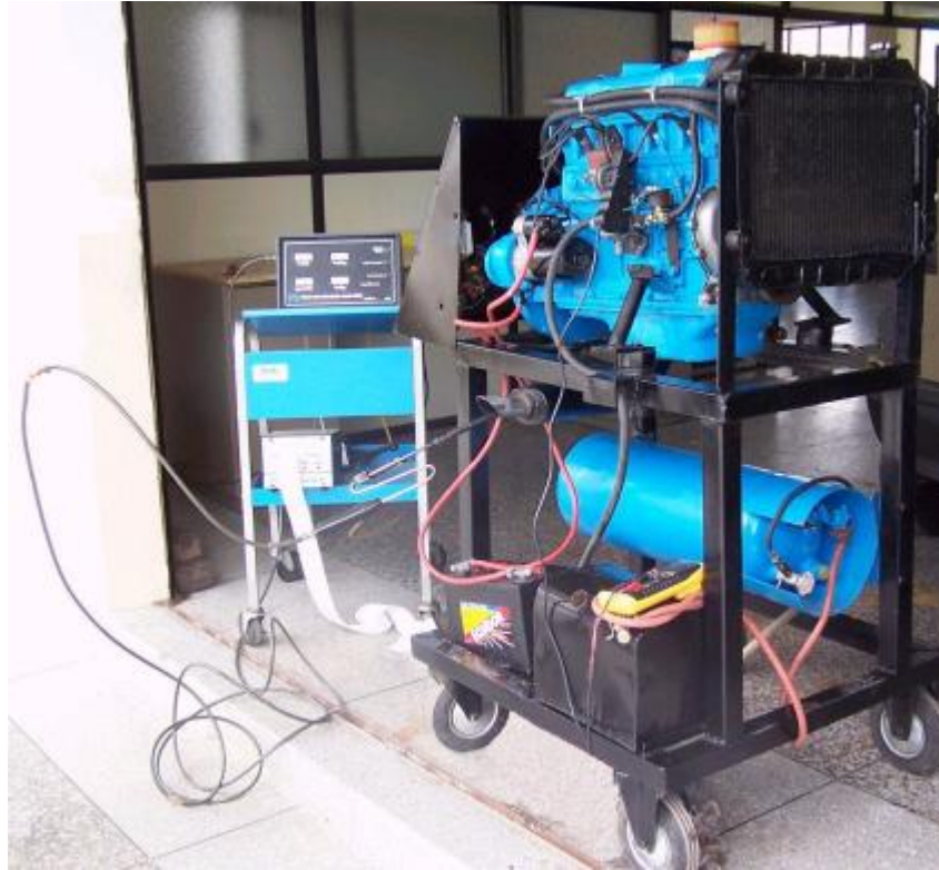
Figura. 4.32 Pruebas con el analizador de gases
