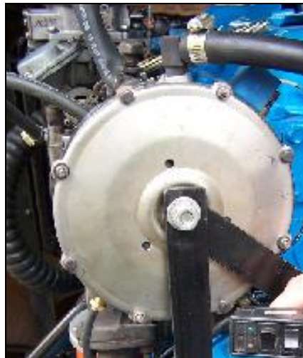
Figura. 4.9 Montaje del Reductor-Vaporizador
