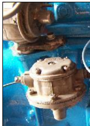
Figura. 4.5 Bomba de gasolina
