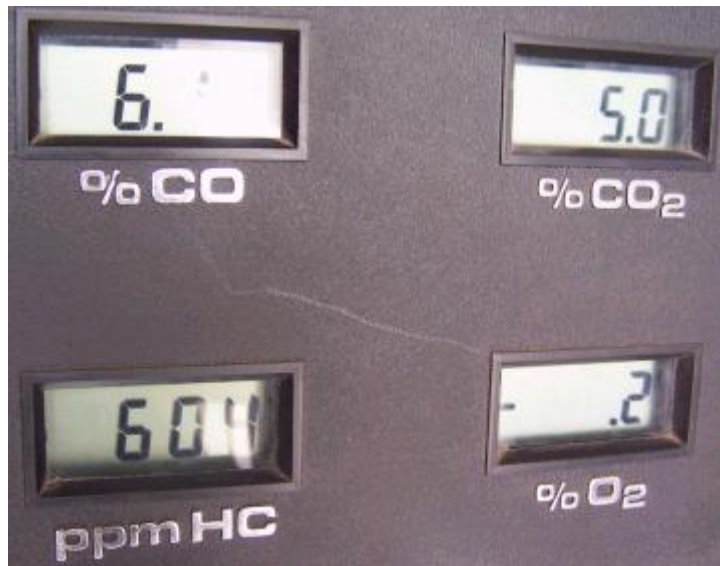
Figura. 4.44 Datos del analizador de gases con gasolina Exceso de ppm HC y bajo CO 2
