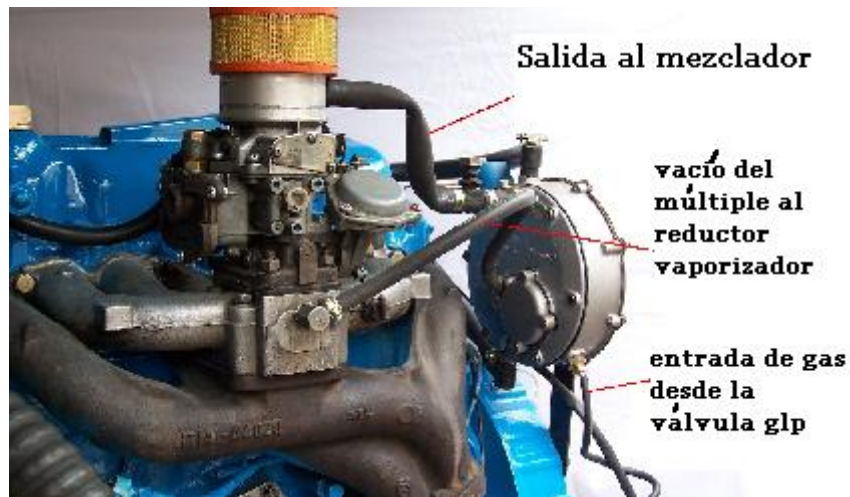
Figura. 4.14 Cañerías de gas.
