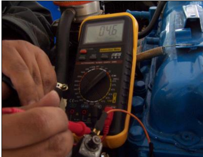
Figura. 4.49 Resistencia de la electroválvula del reductor-vaporizador
