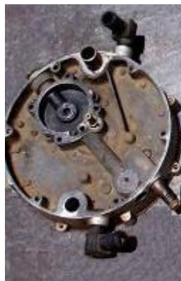
Figura. 4.16 Vista de la cámara de agua
