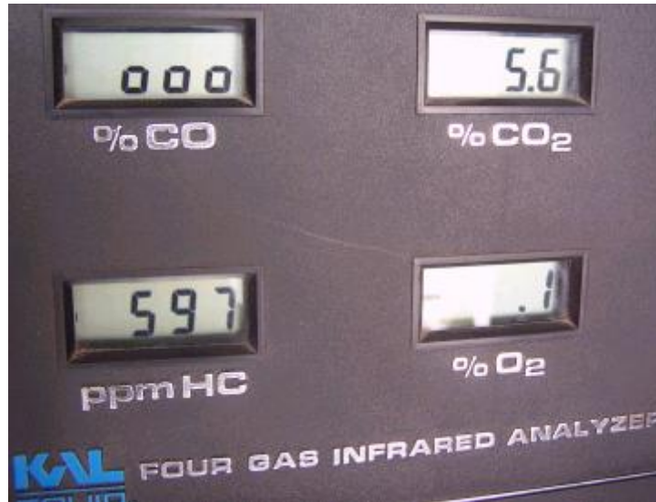
Figura. 4.42 Datos del analizador de gases (Demasiado %CO fuera de rango)
