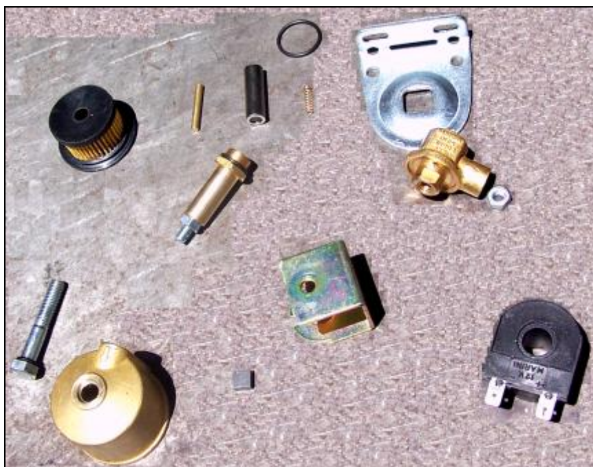
Figura 4.25 Electroválvula GLP desarmada
