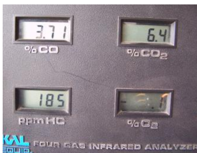
Figura. 4.34 Datos del analizador de gases con GLP
