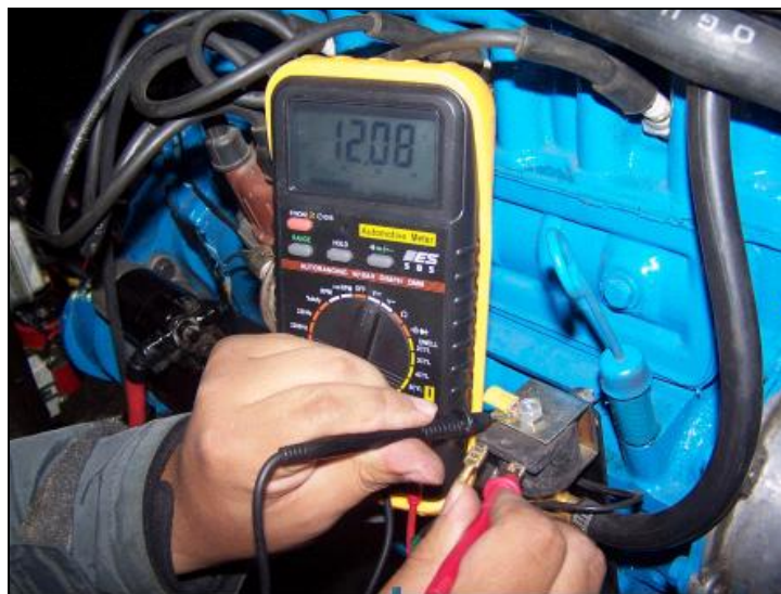
Figura. 4.46 Voltaje de activación de la electroválvula de gasolina
