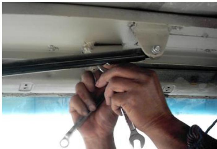
**Figura 3.28 Fijación de la cola del amortiguador**
