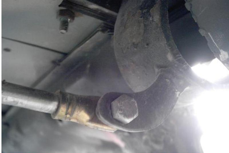
**Figura 3.29 Fijación del amortiguador a la guía**
