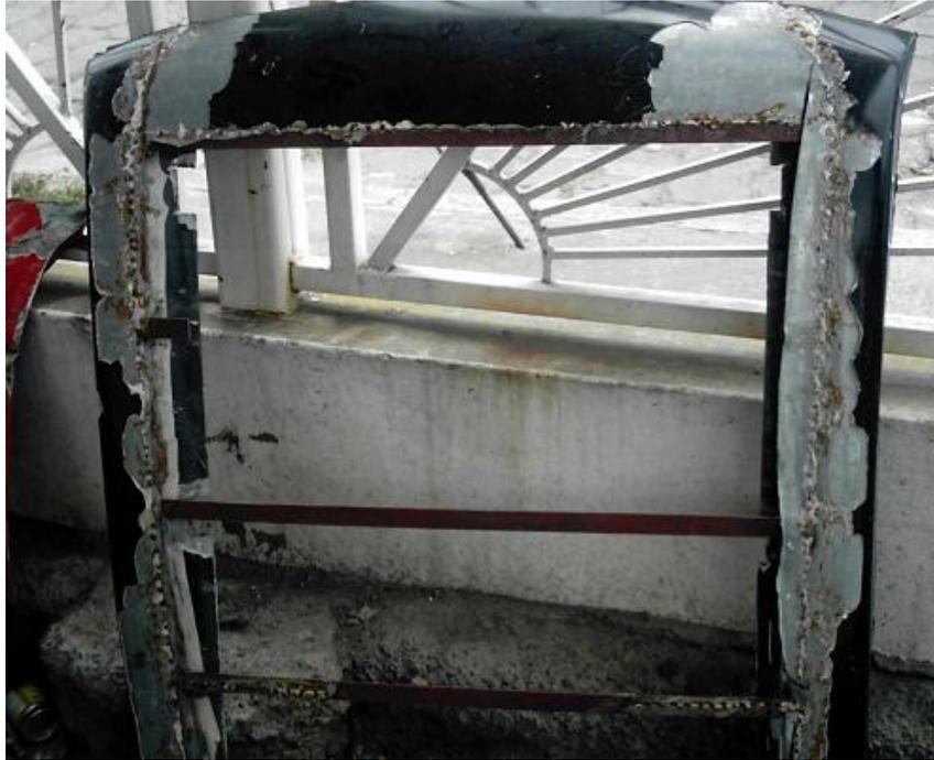
**Figura 3.32 Molde metal del techo**
