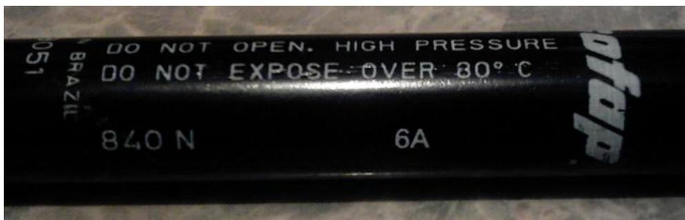
**Figura 2.33 Amortiguador seleccionado**
