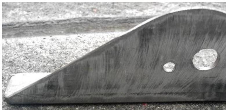
**Figura 3.8 Cambio de forma del apoyo de la bisagra**
