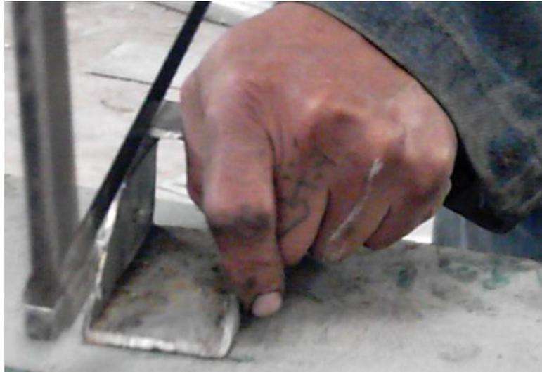
**Figura 3.7 Corte superior del tubo**
