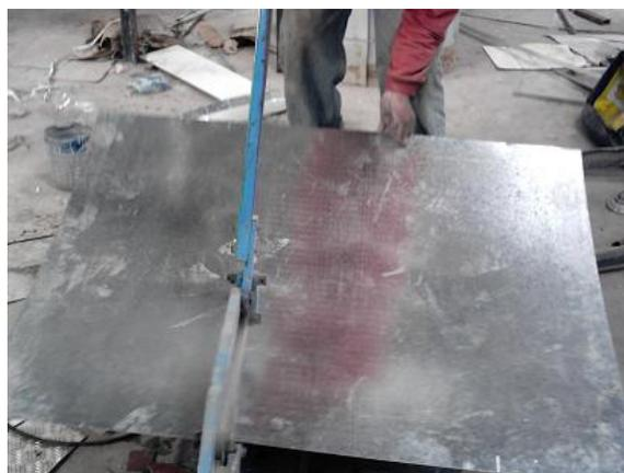
**Figura 3.22 Corte de la plancha**
