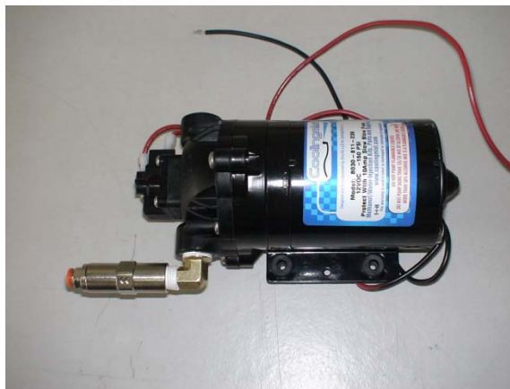
Figura 5.5 Instalación del acople rápido.
