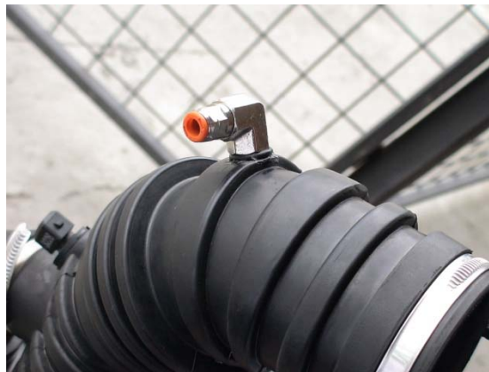
Figura 5.14 Inyector completo atornillado al conducto de la toma de aire.
