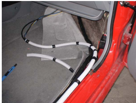
Figura 5.25 Ubicación del cableado en el interior del vehículo.
