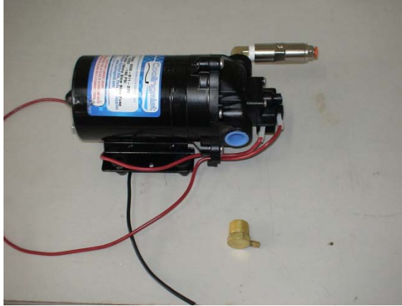
Figura 5.6 Elemento de unión para la entrada de agua.
