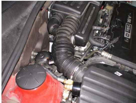
Figura 5.30 Conjunto inyector y manguera.
