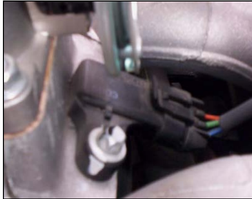
Figura 1.4 Sensor de presión absoluta en el colector de admisión (MAP)
