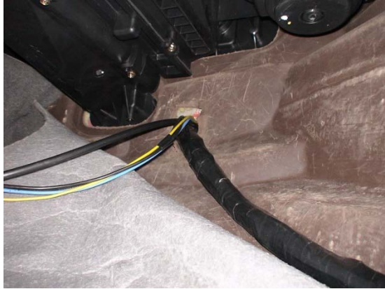
Figura 5.26 Cables y manguera antes de pasar al motor.
