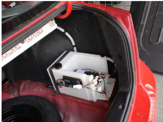
Figura 5.20 Montaje del conjunto bomba y depósito.
