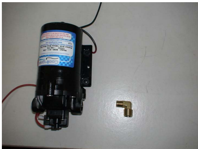
Figura 5.3 Conjunto bomba y acople de salida
