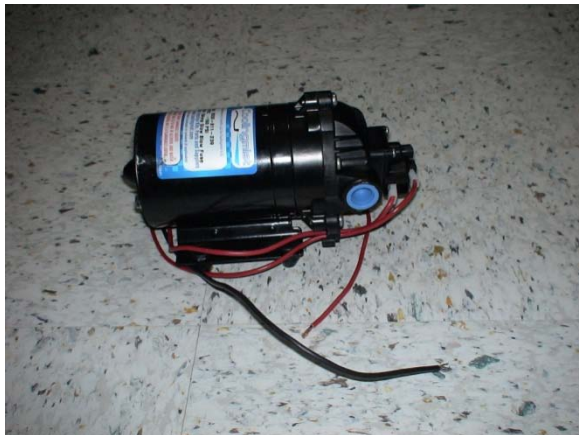
Figura 5.1 Bomba de alimentación de agua con sus protecciones
