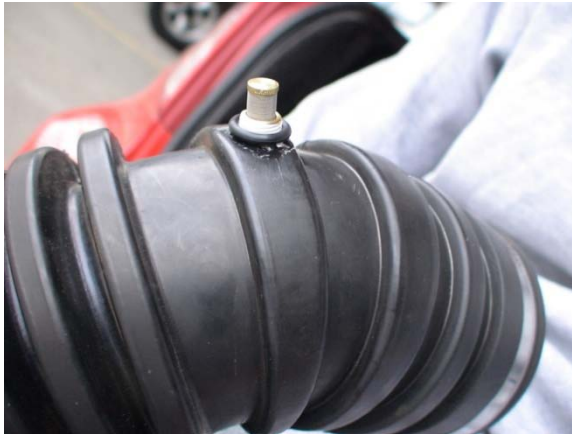
Figura 5.13 Cuerpo del inyector atornillado al conducto de la toma de aire.
