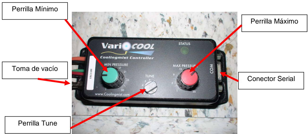
Figura 4.3 Modulo de control y regulación.
