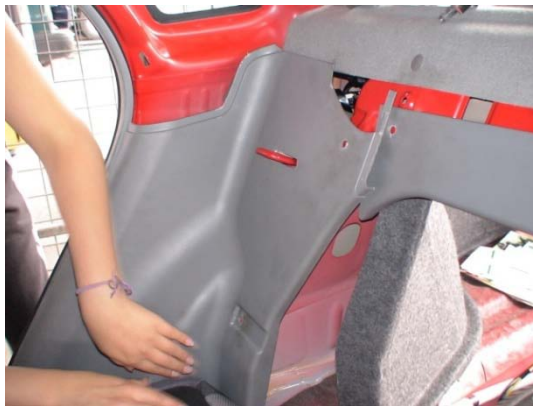
Figura 5.22 Molduras retiradas para el tendido del cableado.
