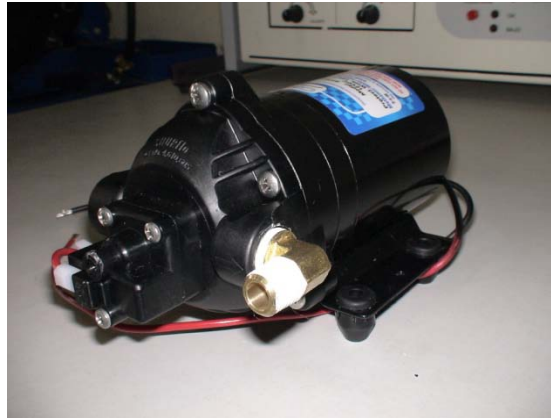
Figura 5.4 Acople instalado en la salida de la bomba.
