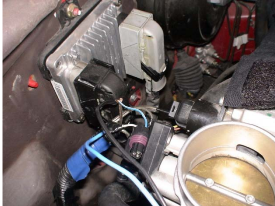
Figura 5.28 Conexión de cables al TPS.
