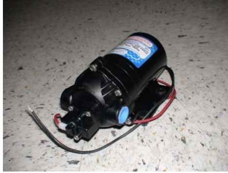
Figura 6.11 Bomba de suministro de agua.
