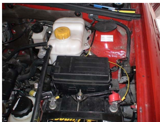
Figura 5.29 Conexión de la alimentación del equipo a la batería.
