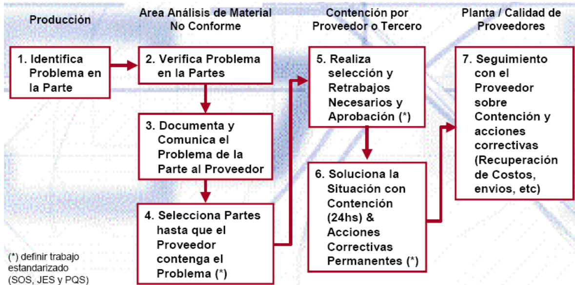
Fig. 2.15. Problemas con partes de proveedor
