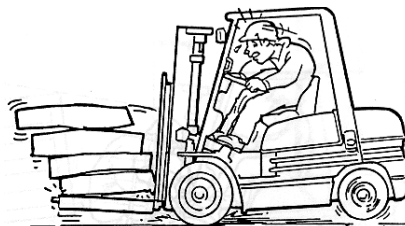
Fig. 10.23 Arranque y pare el montacargas gradual y lentamente
