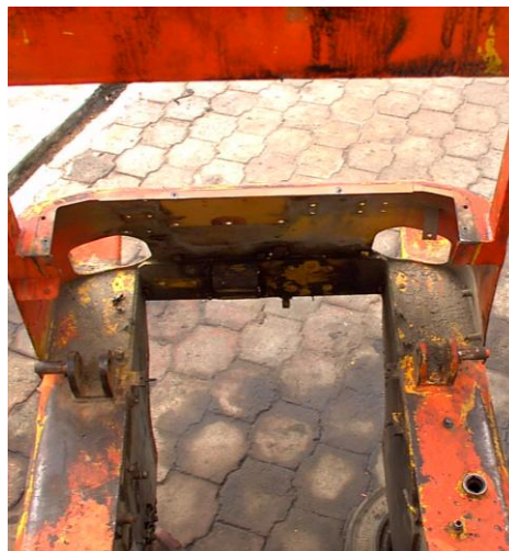
Fig. 6.3 Desprendimiento y oxidación de la pintura
