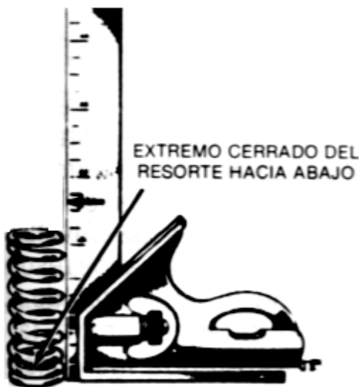
Fig. 3.22 Revisión de los resortes de las válvulas
