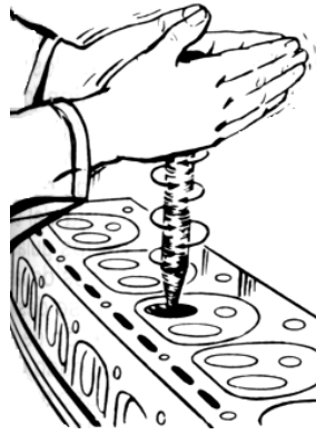
Fig. 3.21 Asentado de las válvulas
