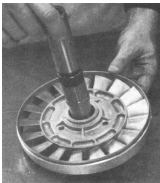
Fig. 4.10 Eje falso de un estator
