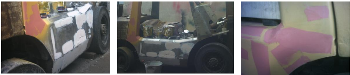
Fig. 6.8 Aplicación de las masillas
