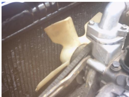
Fig. 7.8 Inspección de la correa del ventilador
