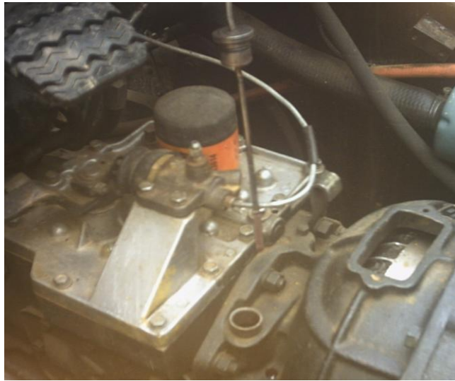
Fig. 7.10 Inspección del aceite del convertidor de par
