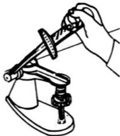
Fig. 3.23 Medición de la presión del resorte
