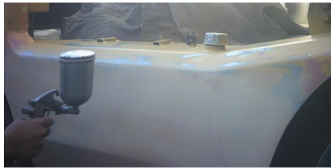
Fig. 6.7 Aplicación de la base - fondo
