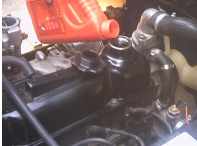
Fig. 7.2 Adición de aceite del motor
