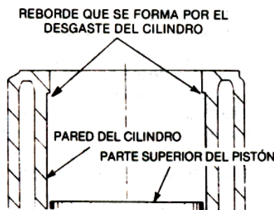
Fig. 3.29 Reborde de la parte superior del cilindro
