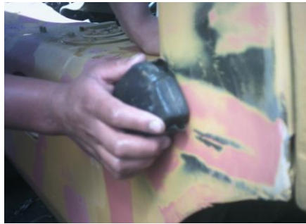
Fig. 6.9 Lijado de la masilla
