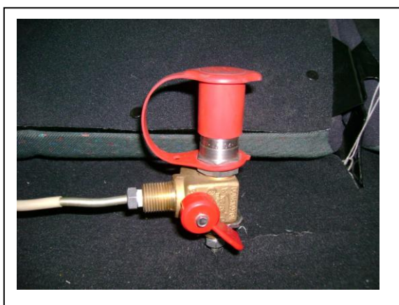
Figura 4.14 Posición de la válvula de carga en el Vehículo
