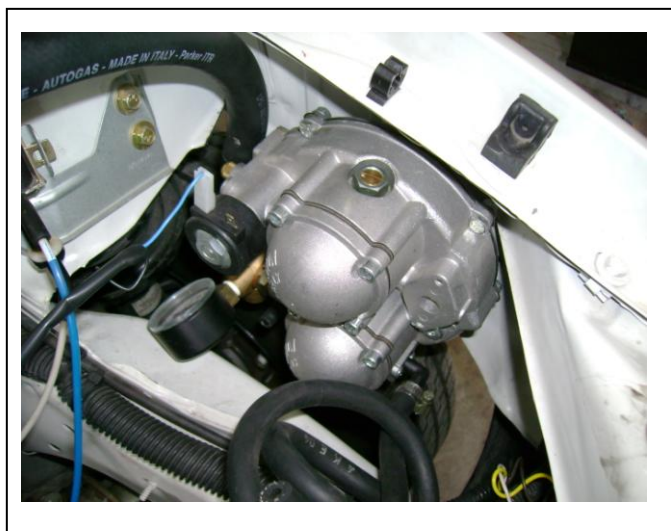
Figura 4.13 Posición del regulador en el Vehículo
