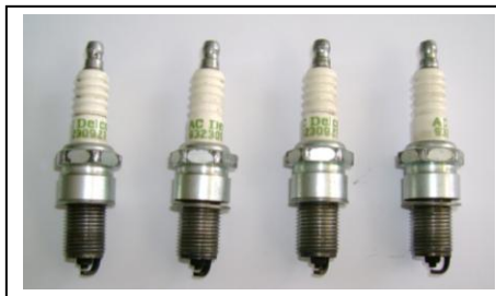
Figura 4.2 Verificación del estado de las bujías
