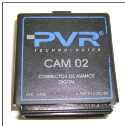
Figura 3.6 Variador Electrónico de Avance
