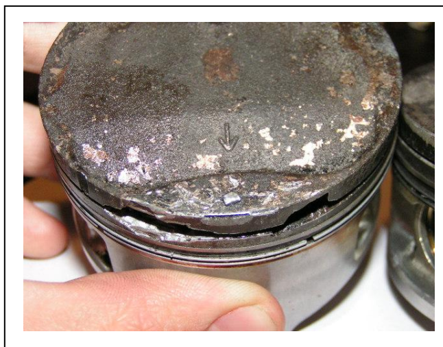
Figura 1.2. Efectos de la detonación en el émbolo
