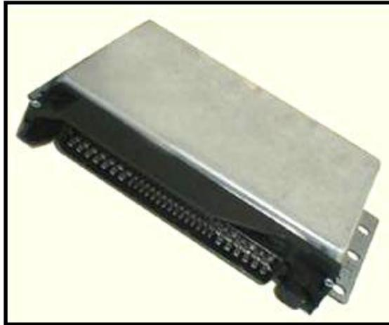
**Figura. 3.3 Unidad de Control Electrónico.**
