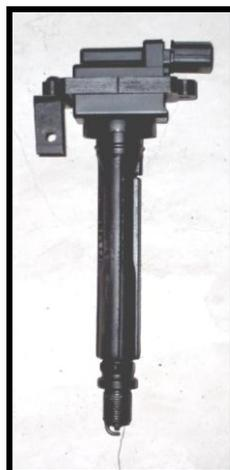
**Figura. 4.2 Bobina de Encendido.**
