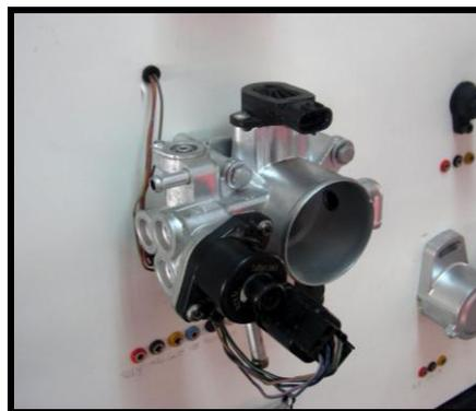
**Figura. 5.24 Sensor TPS y Válvula IAC.**
