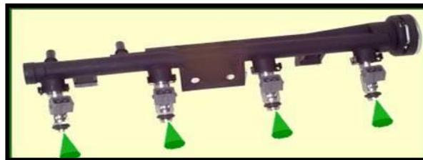
**Figura. 1.11 Inyección Simultánea.**
