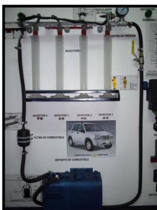
La Unidad Electrónica de Control recibe y procesa las señales enviadas por cada uno de los sensores y determina cuánto tiempo deberán permanecer abiertos los inyectores de combustible y el momento exacto de encendido, además, controla continuamente los datos aportados, garantizando así tanto el servicio como la economía óptima del vehículo y emitiendo una cantidad mínima de gases de escape y materias nocivas.
