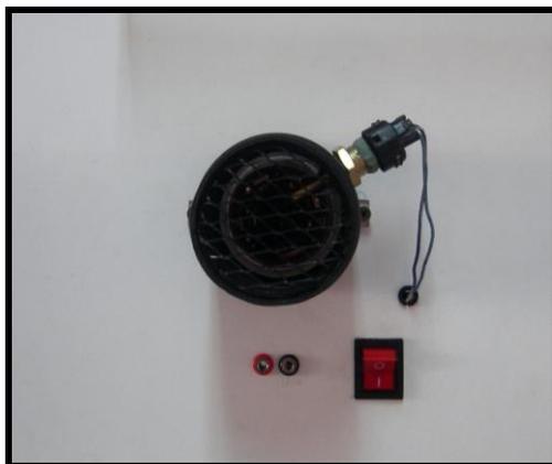
**Figura. 5.20 Sensor de Temperatura de aire**
