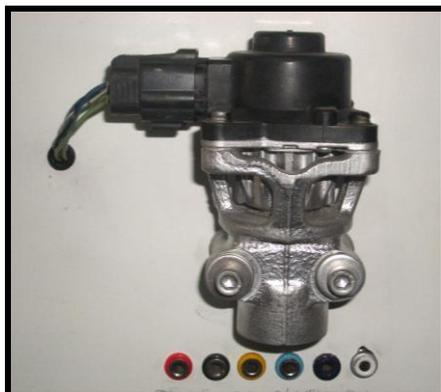
**Figura. 5.28 Válvula de recirculación de gases de escape.**
