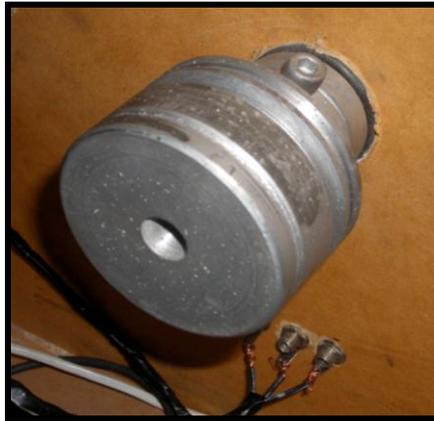
**Figura. 5.13 Polea acoplada al sensor CMP**
