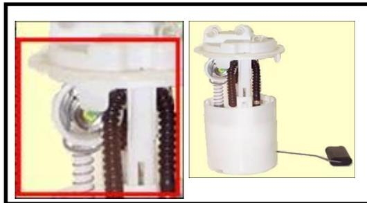
**Figura. 1.50 montajes del regulador de presión.**
