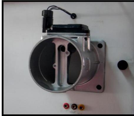
**Figura. 5.25 Sensor de Flujo Másico de Aire.**
