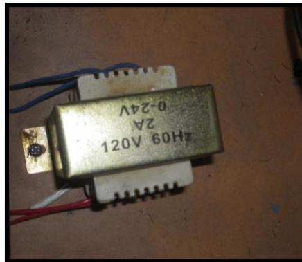
**Figura. 5.23 Transformador de 120V a 24V.**
