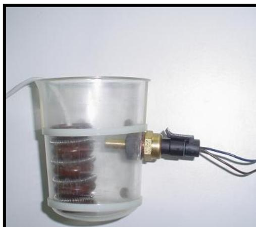
**Figura. 5.22 Sensor de Temperatura del refrigerante.**
