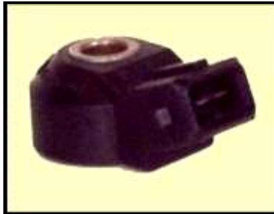
**Figura. 1.35 Sensor de Detonación.**
