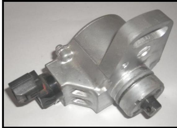
**Figura. 3.6 Sensor de posición del árbol de levas.**
