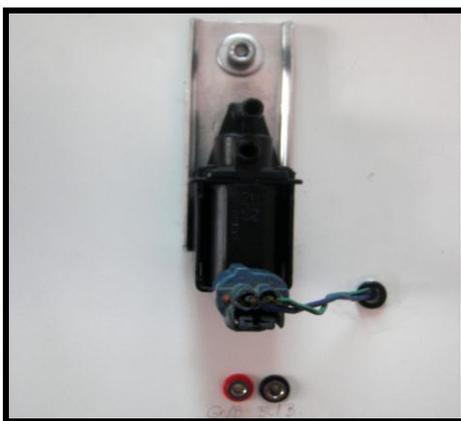
**Figura. 5.27 Válvula de purga del canister.**
