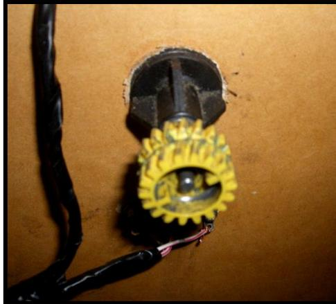
**Figura. 5.15 Rueda Dentada del Sensor VSS**
