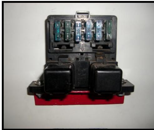
**Figura. 5.32 Caja de Relés y fusibles.**
