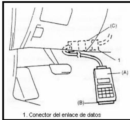
**Figura. 2.8 Diagnostico con la Herramienta TECH**
