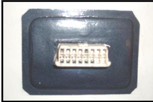
Figura. 5.42 Conector de diagnostico.
