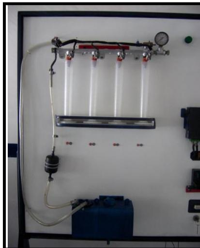
**Figura. 5.37 Circuito de alimentación de combustible.**
