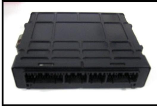
**Figura. 4.1 Unidad Electrónica de Control.**
