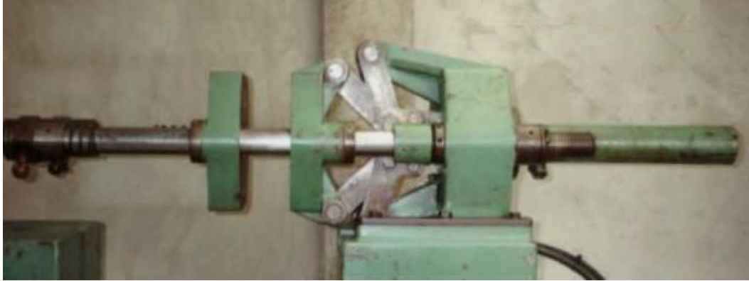
Sistema de cierre – apertura de la matriz, por de arrastre de forma
