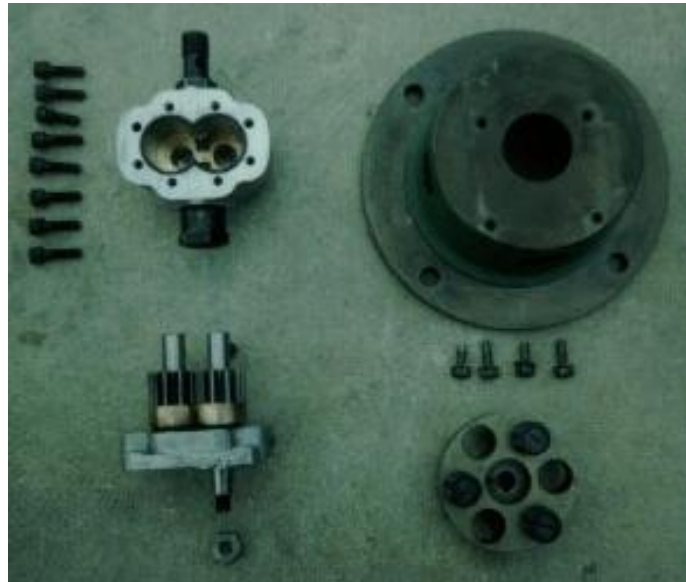
Bomba del sistema oleohidráulico del inyector, la sección superior izquierda se muestra la campana de acoplamiento
