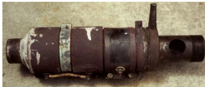
Unidad de inyección, posee tres zonas de calentamiento
