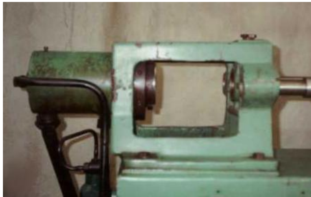
Sistema de inyección por pistón, se puede apreciar el sistema de tuberías del circuito oleohidráulico anterior
