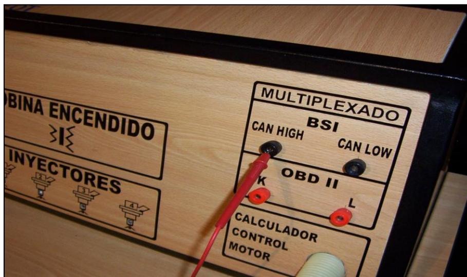
Figura 4.5 Pin de conexión Can HI
