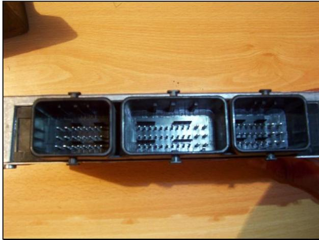
**Figura 3.39 Conector de la ECU**
