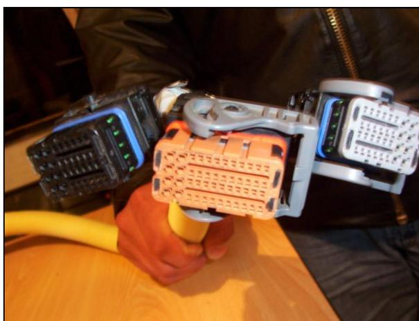
**Figura 3.38 Conector de la ECU del Vehículo**
