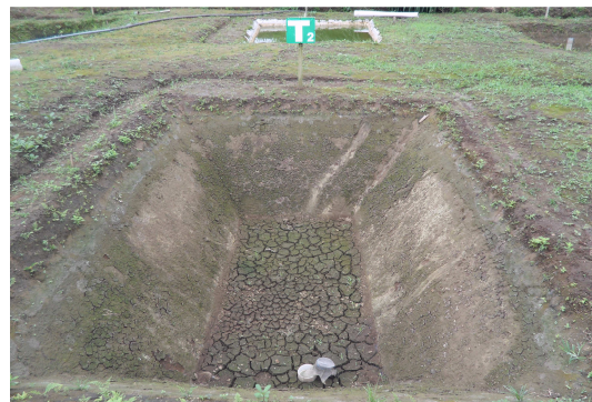
Foto 27. Piscina de bentonita luego de 15 días de vaciado
