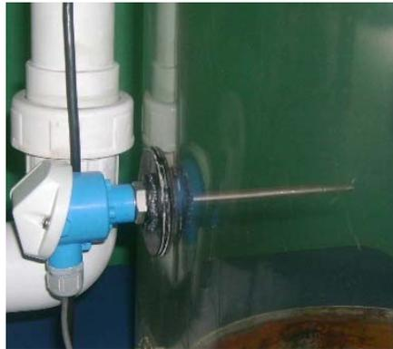
**Figura N° 4.11. Ubicación física del sensor de temperatura TST 41N – DPDN12BAA0 y el transmisor de temperatura TMT 181 – A31AA.**
