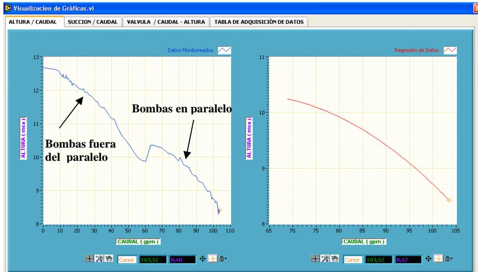
**Figura N° 5.13. Gráfica altura versus caudal obtenidos experimentalmente operación en paralelo bomba “A”(3450 rpm.) y bomba “B”(2950 rpm.)**
