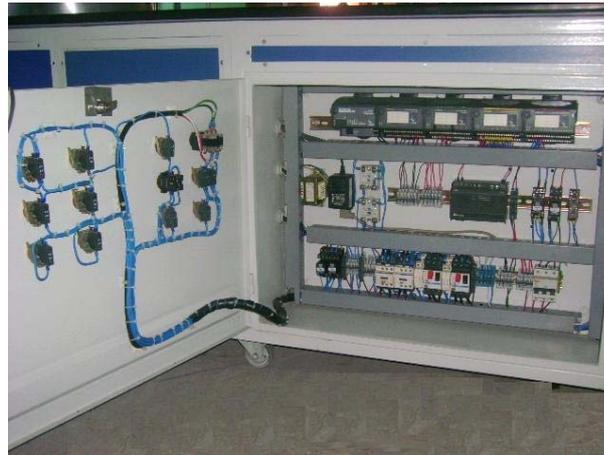
**Figura N° 4.13. Ubicación física del FieldPoint y los automatismos de fuerza y control.**
