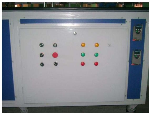
**Figura N° 4.12. Ubicación física del tablero de control y los variadores de velocidad ATV11HU18M2A.**
