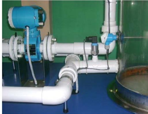
**Figura N° 4.3. Ubicación física de la tubería de succión.**
