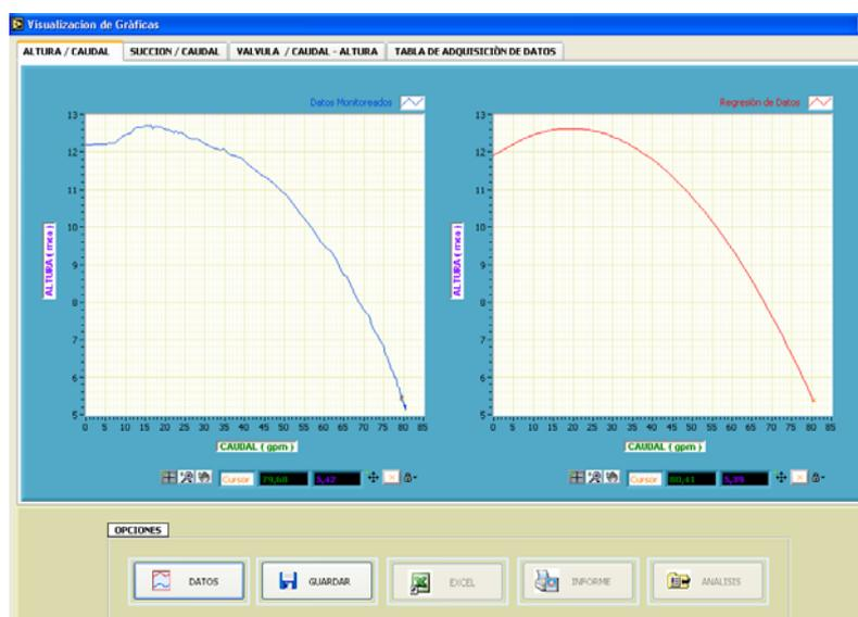
**Figura N° 5.8. Gráfica altura versus caudal obtenida experimentalmente
