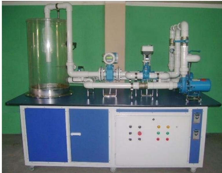
**Figura N° 4.1. Banco de pruebas de operación de bombas hidráulicas centrífugas.**
