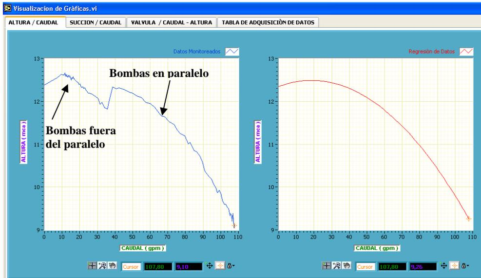
**Figura N° 5.12. Gráfica altura versus caudal obtenidos experimentalmente operación en paralelo bomba “A”(3450 rpm.) y bomba “B”(3450 rpm.)**
