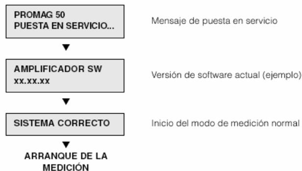
**Figura N° 3.16. Secuencia de operación inicial del medidor de caudal PROMAG.**
