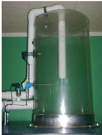
**Figura N° 4.5. Constitución física del depósito de agua del banco de pruebas.**
