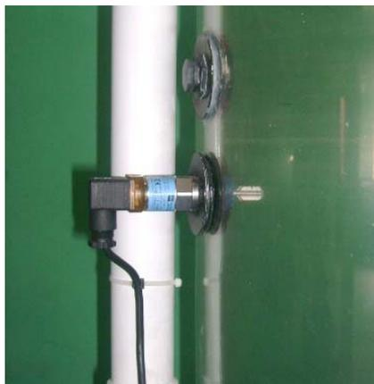
**Figura N° 4.10. Ubicación física del detector de nivel Liquiphant T FTL 20-0214.**
