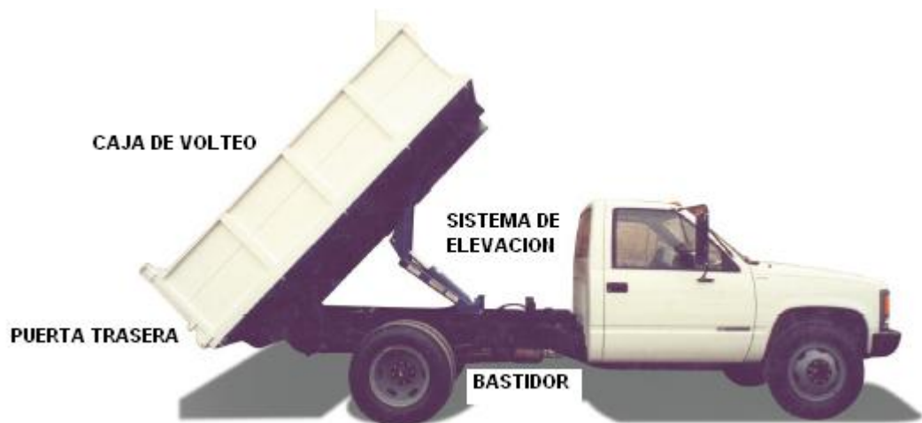
Figura 1.16 Camión de volteo
