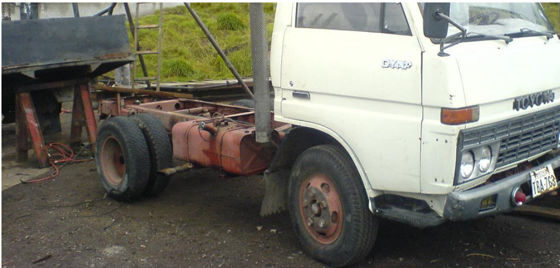
Figura 4.1 Desmontaje del cajón
