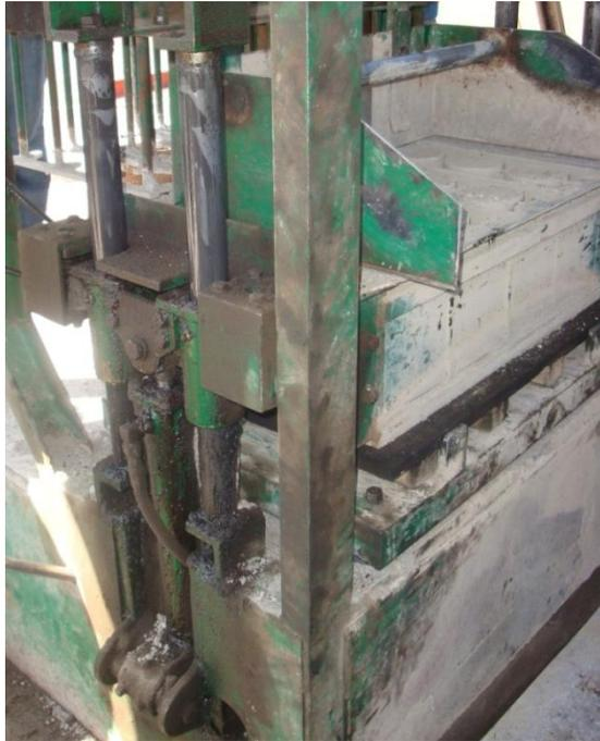
**Figura 2.9: Desmolde del bloque o adoquín**
