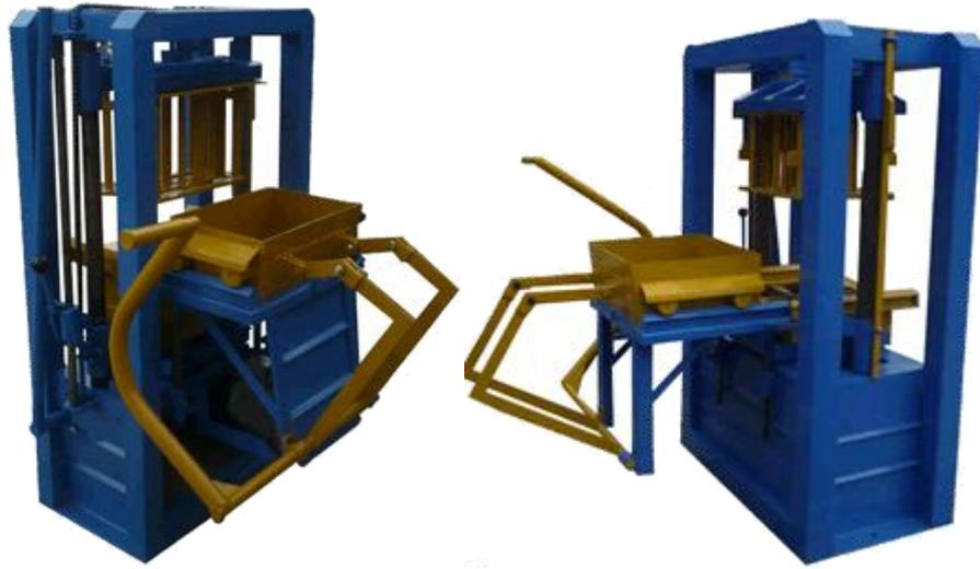
**Figura 2.3: Abastecedor de mezcla**
