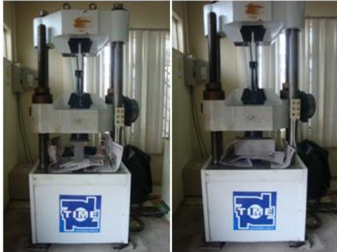
**Figura 3.19: Ensayo de compresión realizado al bloque y al adoquín**
