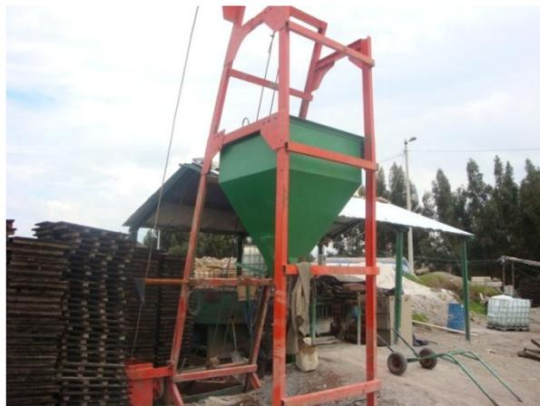
**Figura 2.2: Sistema de elevación por cangilón**
