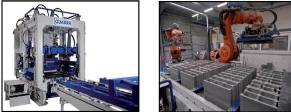
**Figura 1.16: Máquina bloquera y máquina adoquinera automáticas**
