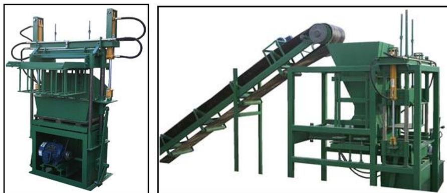
**Figura 1.15: Máquina bloquera y máquina adoquinera semiautomáticas**
