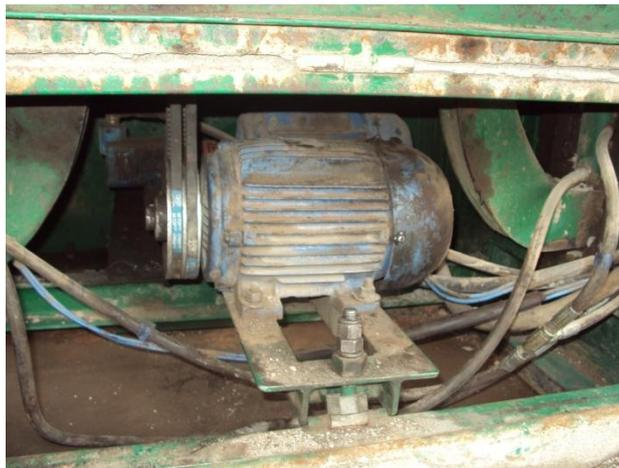
**Figura 2.5: Motor vibrador**
