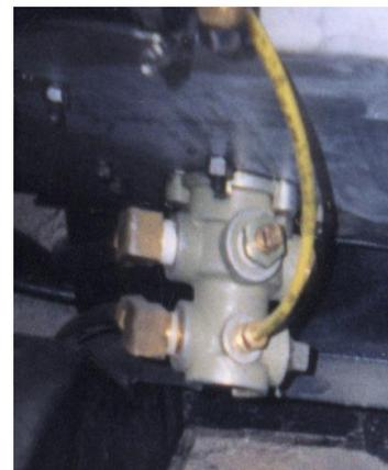
El grifo distribuidor sencillo, o grifo de mando, es alimentado por el depósito de aire comprimido. Está mandado por el pedal de freno y envía el aire comprimido en el momento de frenado.
