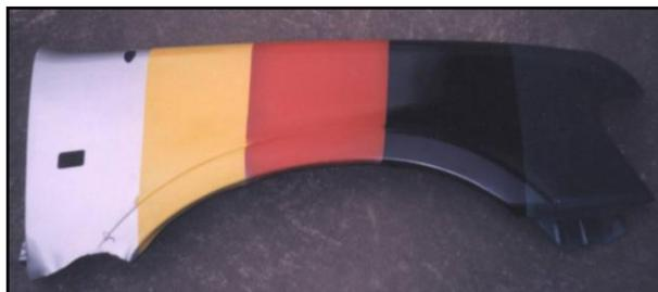
Fig. 6.5 Aplicación de diversos tipos de pinturas
