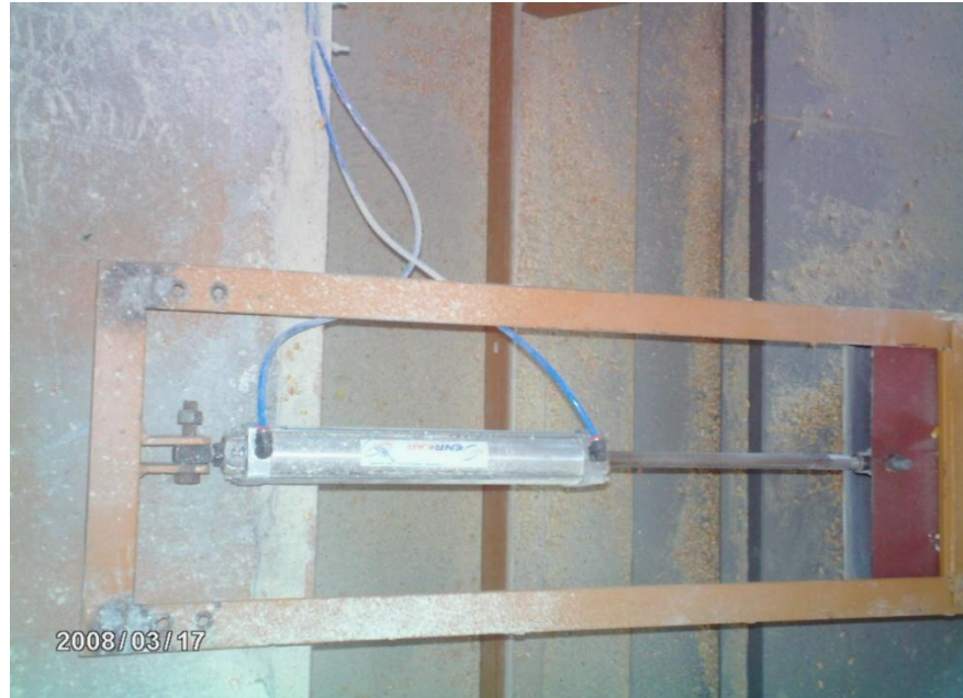
Figura 3.25 Cilindro Doble Efecto de la Tolva de Pesaje
