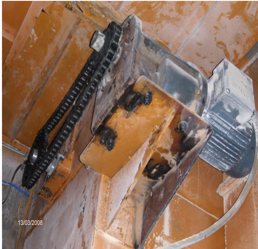
Figura 3.21 Ubicación del Motor de la Mezcladora
