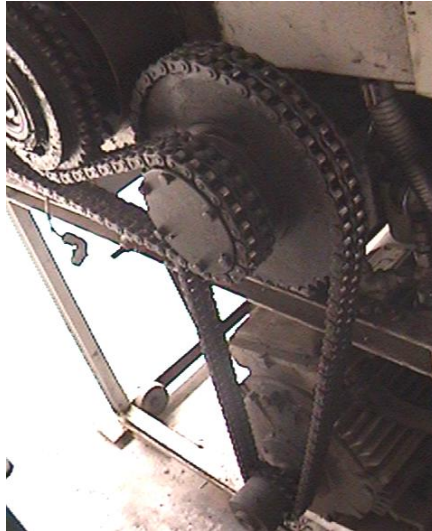
Figura 2.6. Acople del motor con los husillos de inyección.
