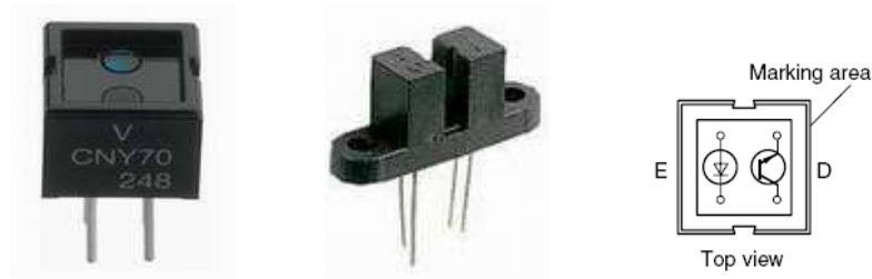
Figura 1.13. Sensor reflectivo, de ranura, símbolo.
