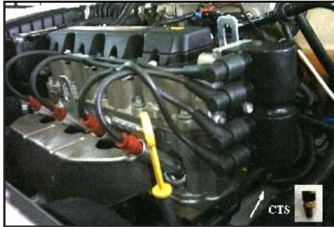
Figura 2.12. Ubicación del Sensor de Temperatura del Líquido de Enfriamiento (CTS).
