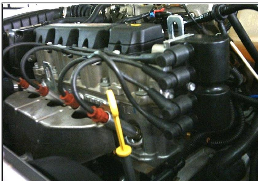
Figura 2.27 Sistema de encendido DIS CORSA WIND
