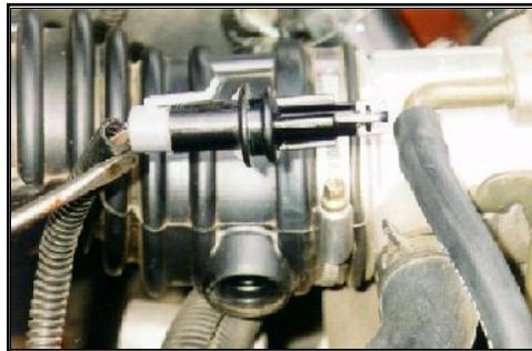
Figura 2.11. Ubicación del Sensor de Temperatura de la Admisión de Aire (IAT o ATS).
