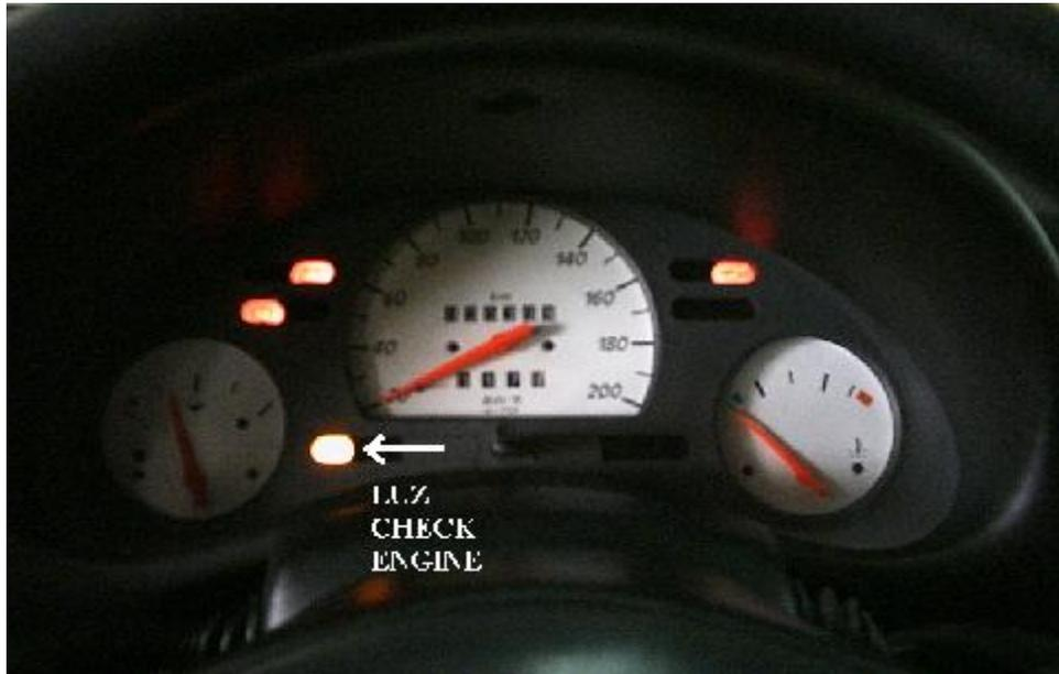
Figura 1.12. Luz check engine **Corsa WIND** de autodiagnóstico.
