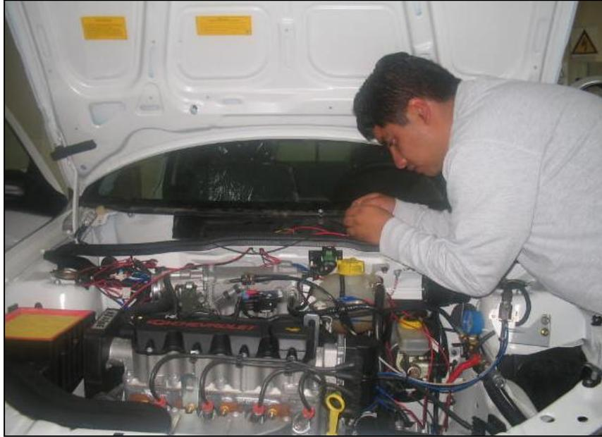
Figura 4.34. Inicio de instalación de cableado.
