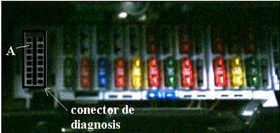
Figura 2.28 Ubicación del conector ALDL Corsa WIND
