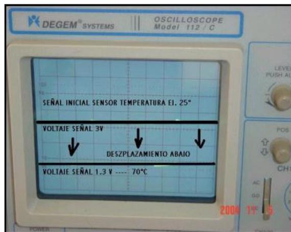
Figura 1.31. Señal de sensores de temperatura en función del tiempo
