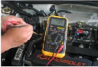
Figura 5.14. Pruebas del sensor ATS( Sensor de Temperatura del aire). Del vehículo “CORSA WIND”.
