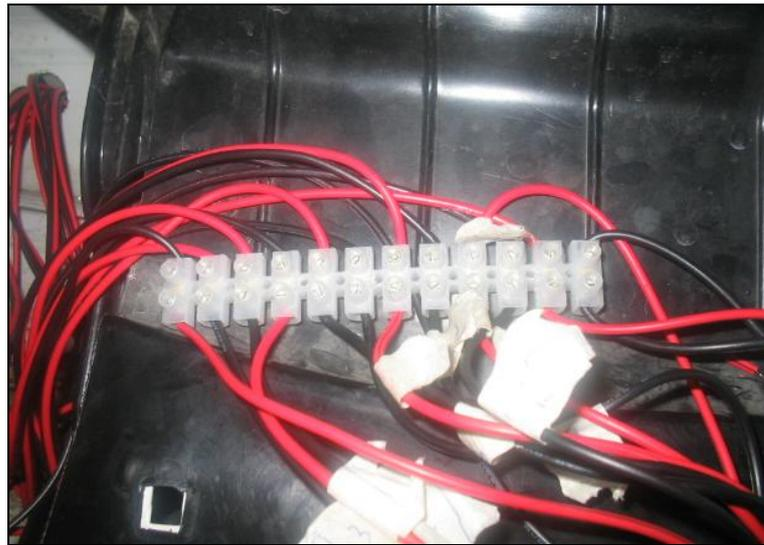
Figura 4.36 Bornera para puntos de medición.
