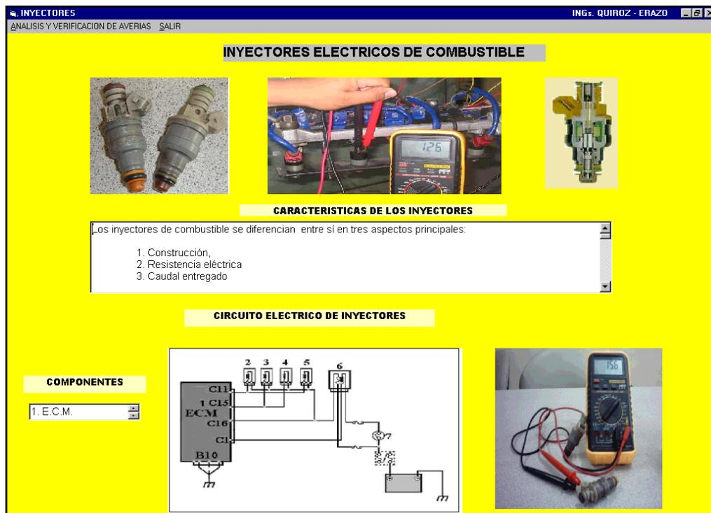
Figura 5.26. Circuito, Ubicación, en información de Inyectores de Combustible del vehículo “CORSA WIND”.
