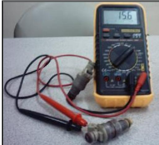
Figura. 1.24. Medición de resistencia del Inyector.
