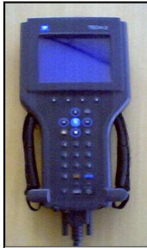
Figura. 1.20. Escáner Tech 2
