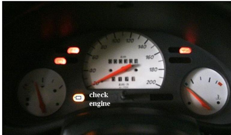
Figura 2.27. Luz Check engine en el tablero de instrumentos corsa
