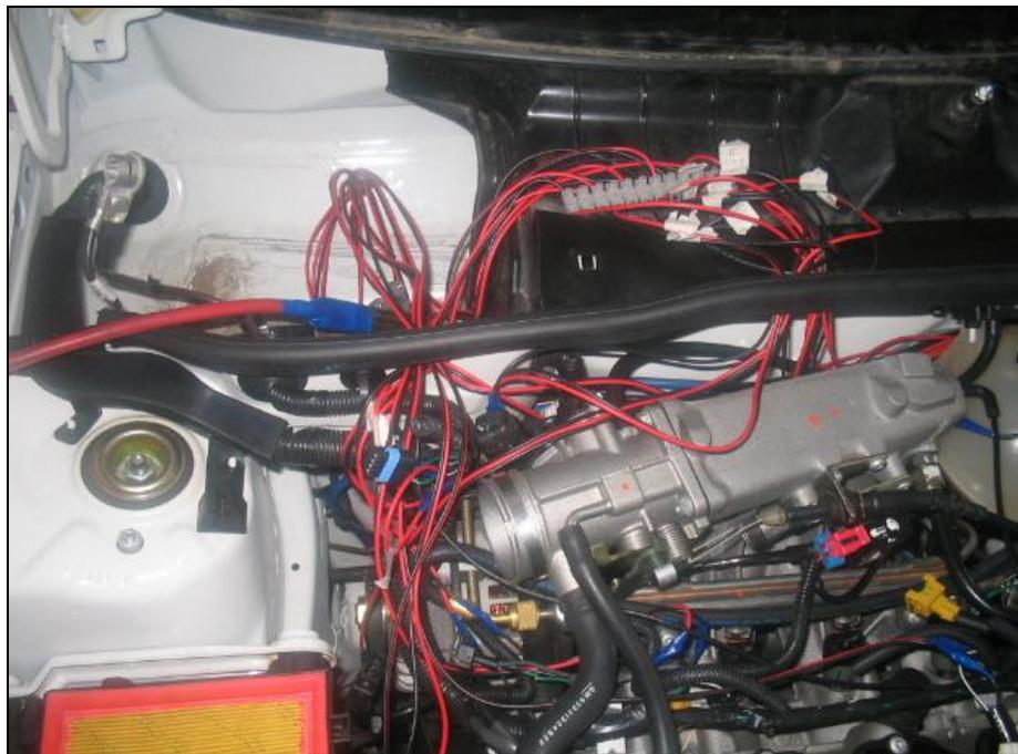
Figura 4.35 Cableado del módulo de entrenamiento en el compartimiento del motor.
