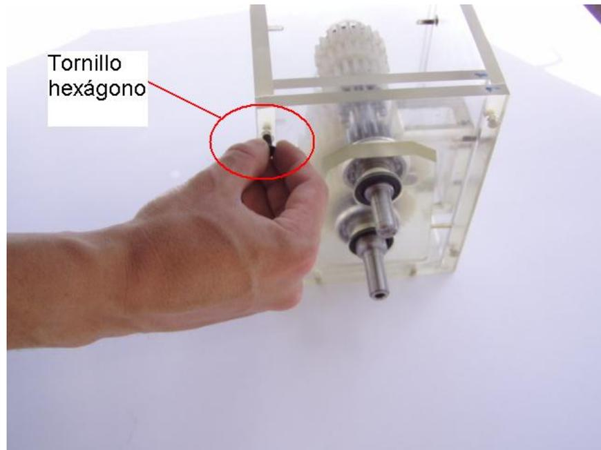
**Fig. 6.2 Tornillos en tapa que contienen a los retenedores**
