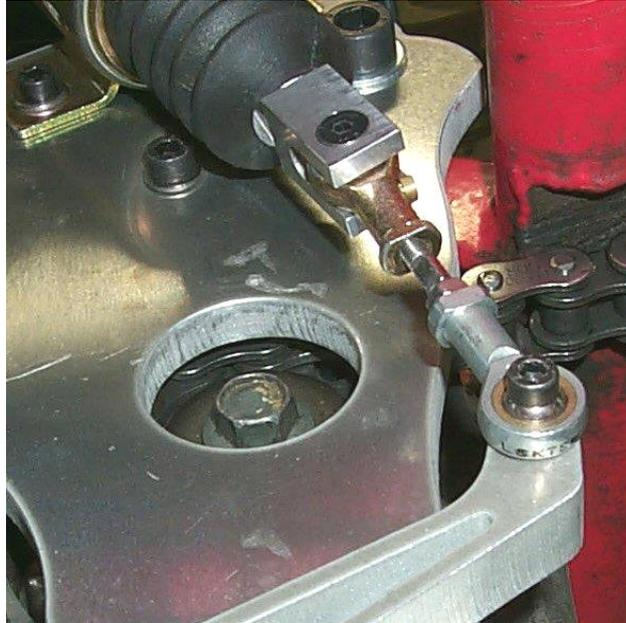
**Fig. 2.71 Acople solenoide Brazo actuador**
