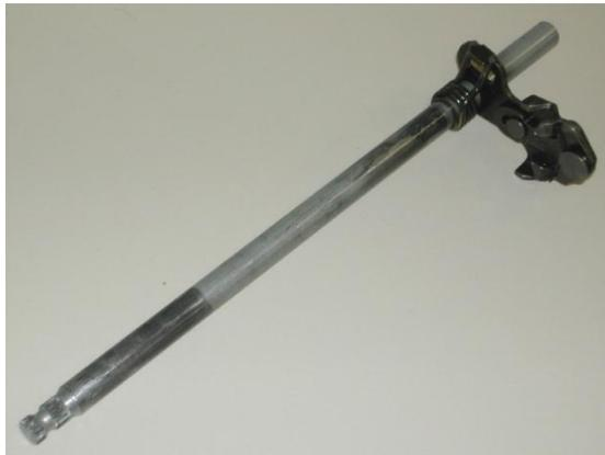
Fig. 2.63 Eje selectora de marcha
