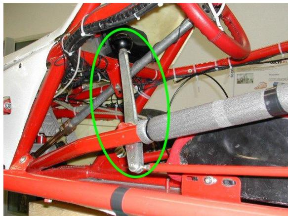
**Fig. 2.60 Accionamiento por palanca**
