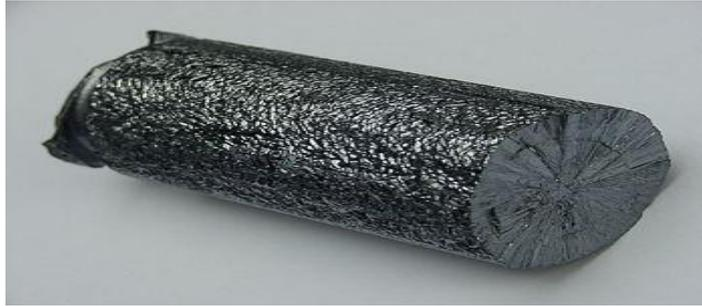
**Figura.1.14. Barra de silicio policristalino**
