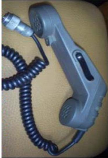
**Fig. 1.5** Microteléfono (ST719215 o ST711013)
