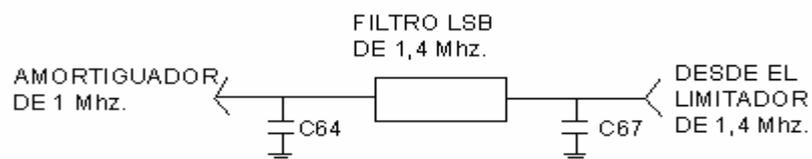
**Fig. 2.6. Filtro LSB (banda lateral inferior) de 1,4 Mhz**
