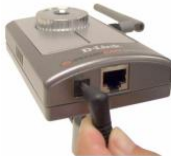
Figura 4.10 Alimentación externa de la cámara IP.
