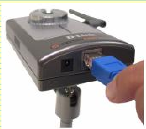
Conexión del cable Ethernet
