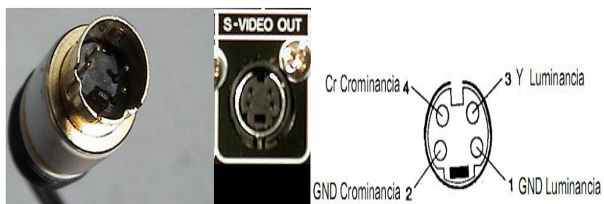
Figura 1.30 Conector de S-Video y distribución de pines.
