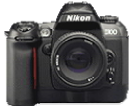
Figura 1.14 Nikon D100, Modelo Reflex con CCD (6 millones de píxeles).
