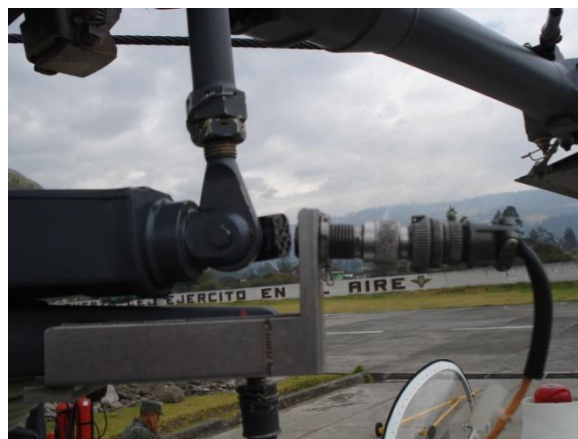
Figura 3.1b. Colocación del interruptor (Placa del captor magnético) y captor magnético.
