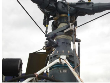
Figura 3.4. Montaje del acelerómetro y detector magnético.
