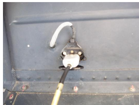
( b ) Conexión a 28Vcc
