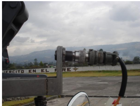
Figura 3.2. Montaje del captor magnético en soporte.
