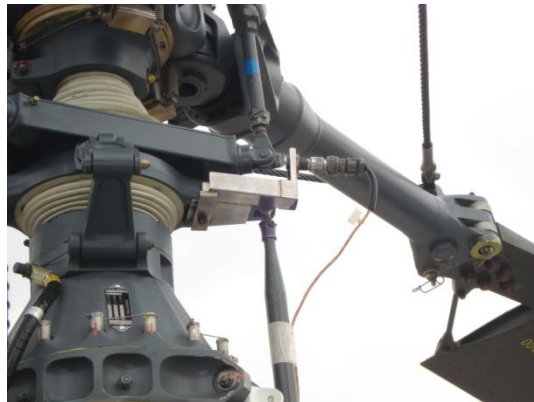
Figura 3.1 a Soporte y captor magnético .
