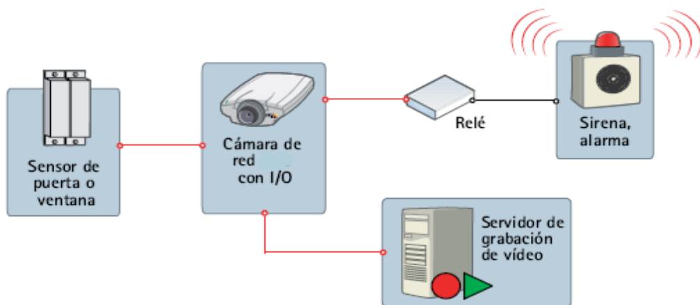
Fig.2.18 Cámara conectada a un sensor de ventana y a un sistema de alarma
