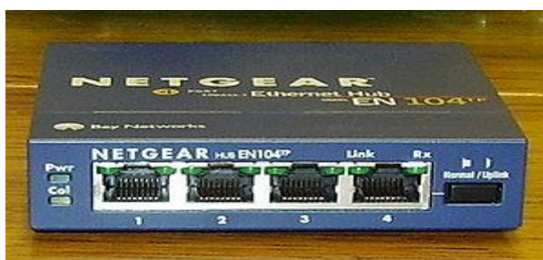
Fig.1.18 Hub para 4 puertos ethernet
