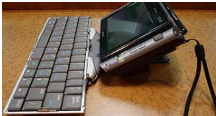
Fig.1.9 Teclado bluetooth enlazado a un computador de bolsillo
