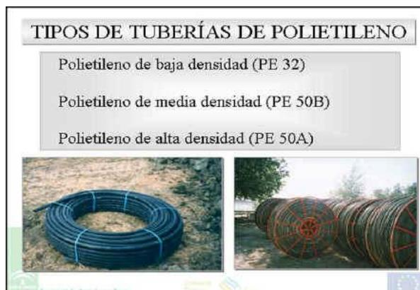
Figura I.2 Tipos de tubería
