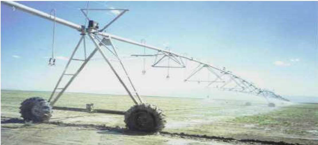
**Figura I.1. Sistema de riego por aspersión <sup>1</sup>**
