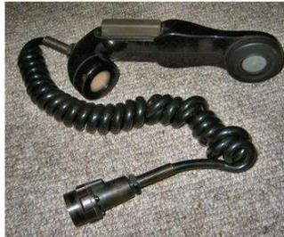
Fig. 2.17. Microteléfono (ST719215 ó ST711013)
