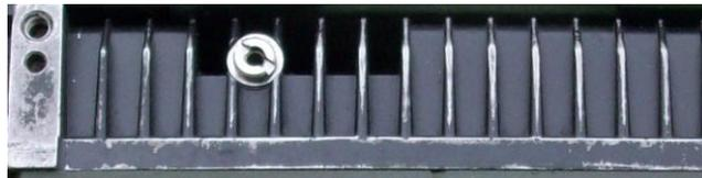
**Fig. 2.14. Toma de Antena ATU**
