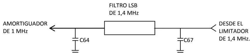
**Fig. 2.31 Filtro LSB (Banda Lateral Inferior) De 1,4 MHz.**
