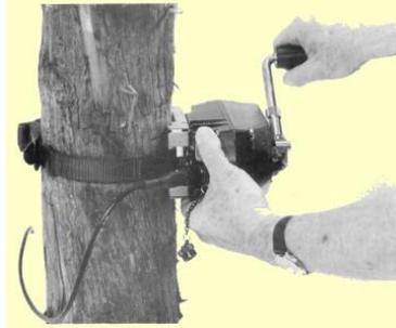
**Fig. 2.21. Generador Manual MA.4175**
