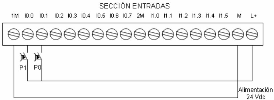
**Figura 5.50. Circuito de conexión de las entradas.**
