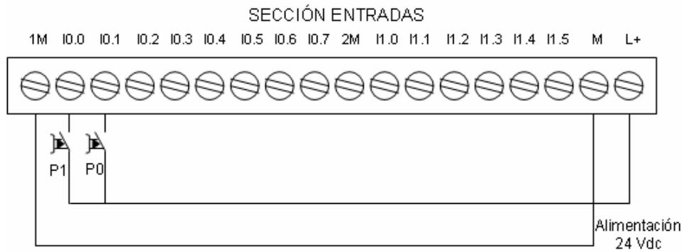
**Figura 5.30** Circuito de conexión de las entradas.
