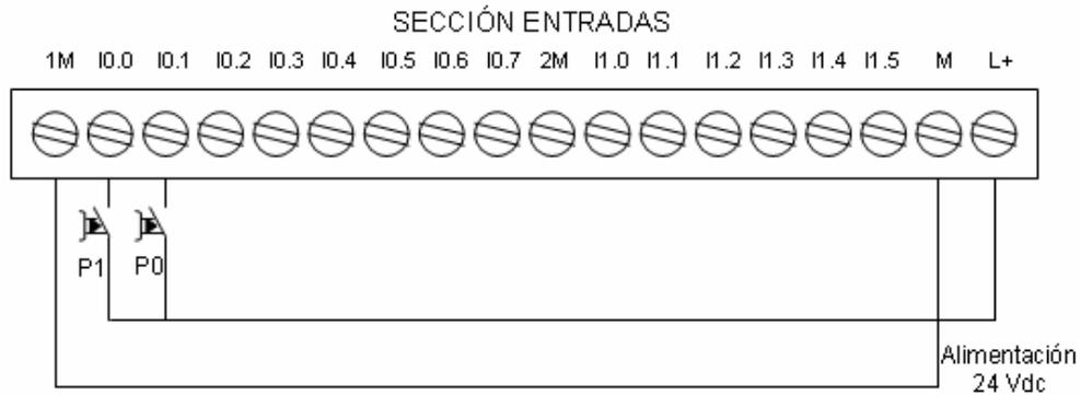
**Figura 5.58. Circuito de conexión de las entradas.**
