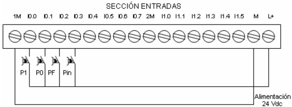
**Figura 5.22 Circuito de conexión de las entradas.**
