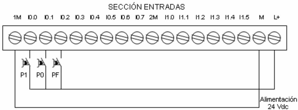
**Figura 5.18 Circuito de conexión de las entradas.**
