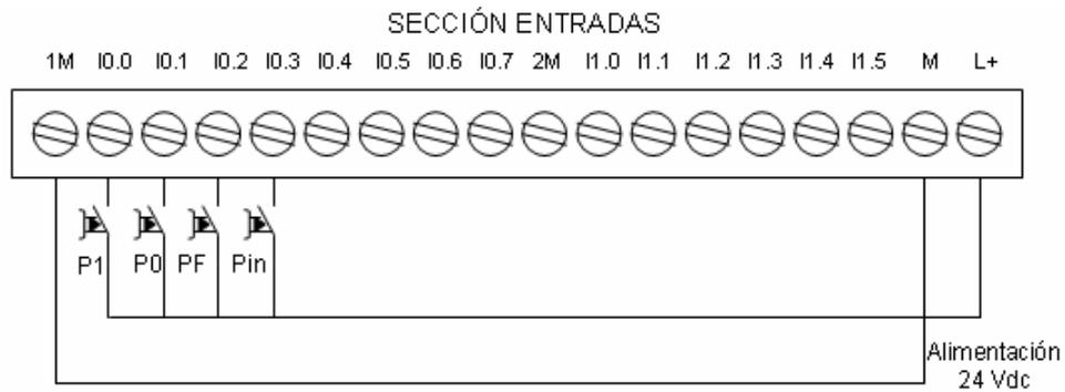
**Figura 5.46 Circuito de conexión de las entradas.**
