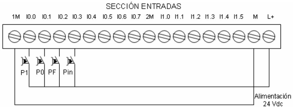
**Figura 5.42 Circuito de conexión de las entradas.**
