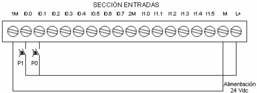
**Figura 5.2 Circuito de conexión de las entradas.**
