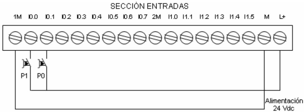
**Figura 5.6 Circuito de conexión de las entradas.**
