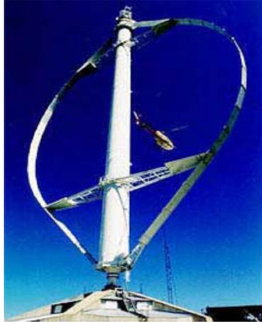
Figura 1.6.- Eole VAWT (aerogeneradores de eje vertical)
