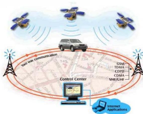
*Ilustración 4.- Esquema utilizado para el rastreo de vehículos*
