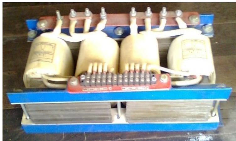
Figura. 2.46 Transformador de 1Kva
