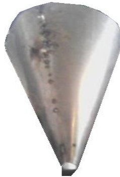
Figura. 3.53 Tolva apuntada para ser soldada
