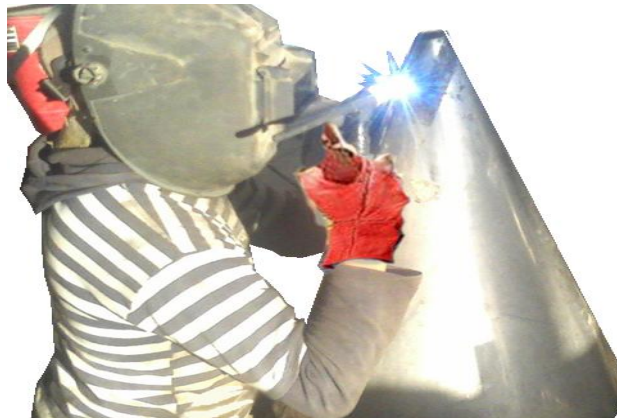
Figura. 3.54 Soldado de tolva
