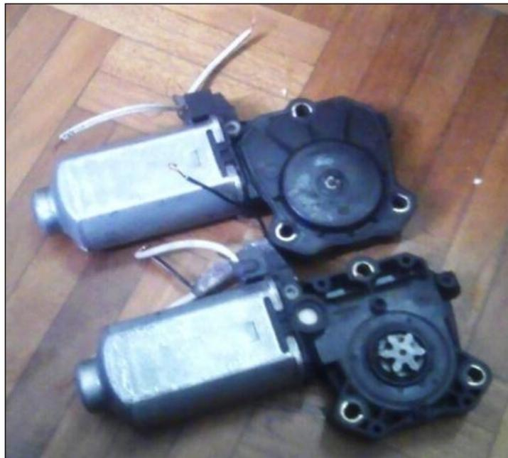
*Figura 2.15 Motores eléctricos de vidrios de automóvil*
