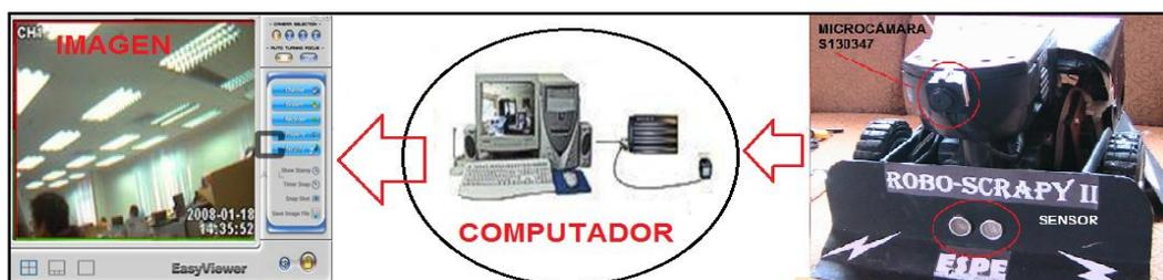
*Figura 2.39 Proceso de digitalización de la imagen*
