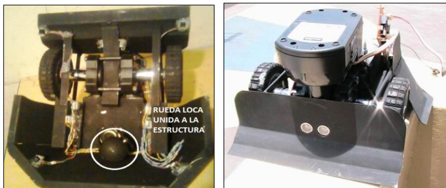
**Figura 2.12 Esquema de locomoción diferencial**
