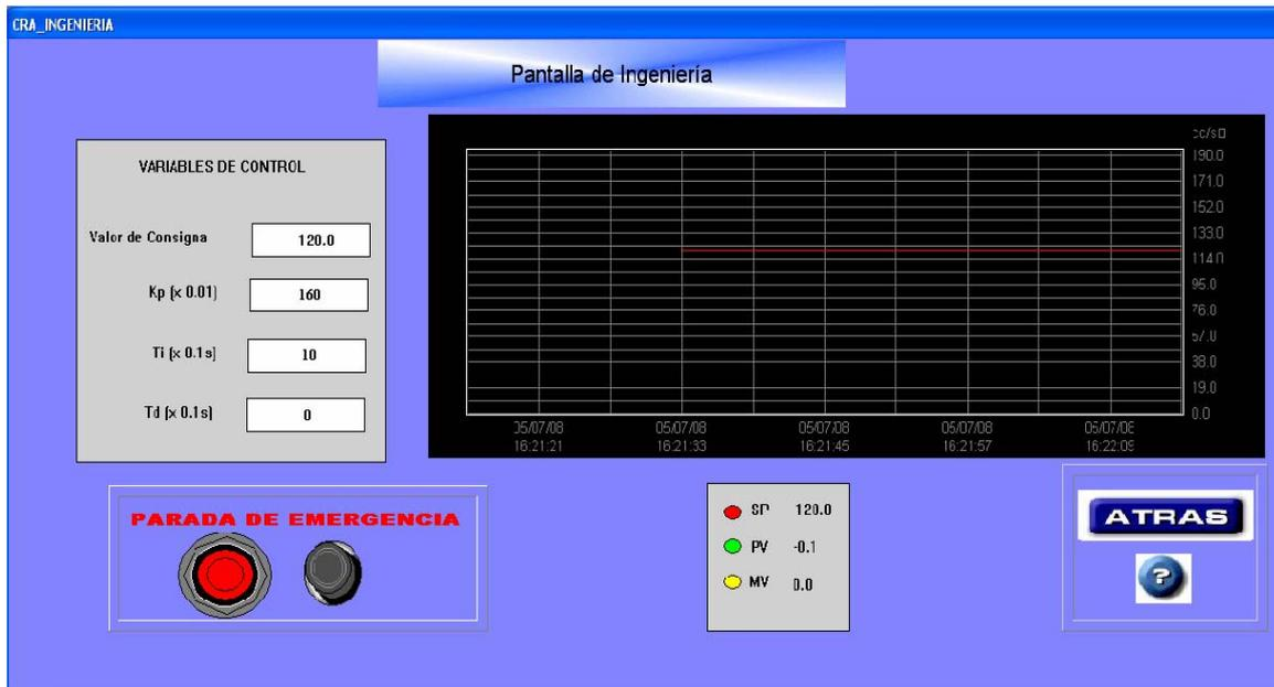
**Figura 6.9.** Ventana de la Interface de Ingeniería para el Controlador de Flujo
