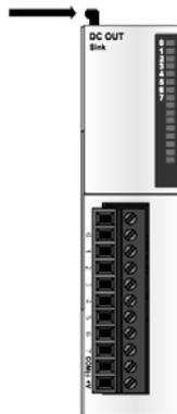
3. Alinear el conector del lateral izquierdo del módulo de ampliación de E/S con el conector del lateral derecho de la base.
