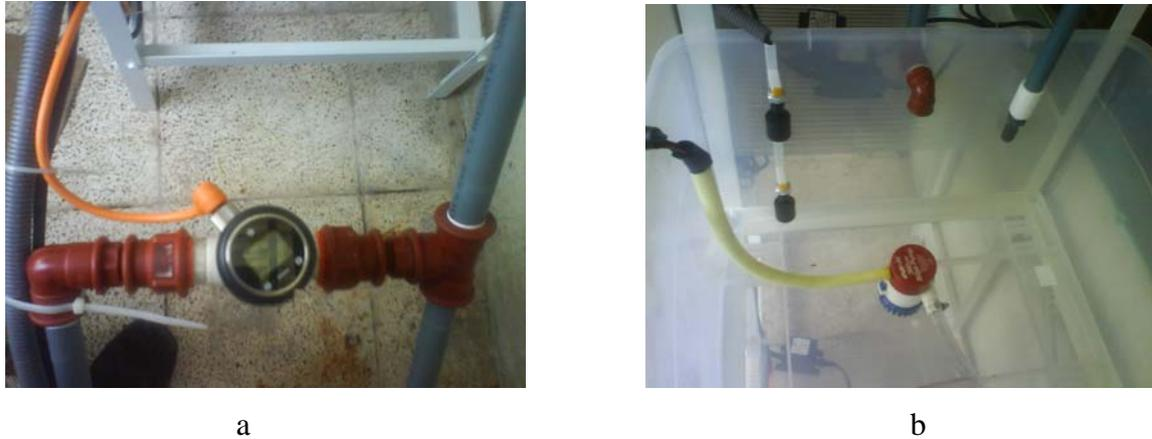
**Figura 7.1.** a) Sensor de Flujo del Sistema. b) Bomba para el control de flujo del Sistema
