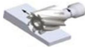
Figura 1.13 Fresado cilíndrico
