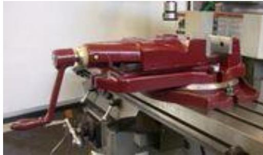
Figura 2.29 Mordazas de accionamiento manual o hidráulico
