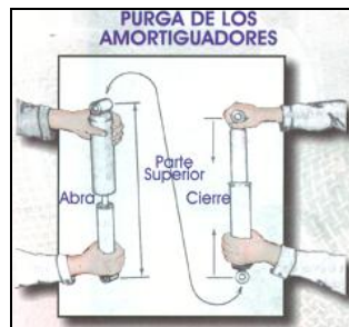
Figura 3.20 Purga de amortiguadores.
