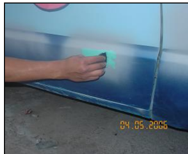
Figura 6.9 Masillado de la puerta.
