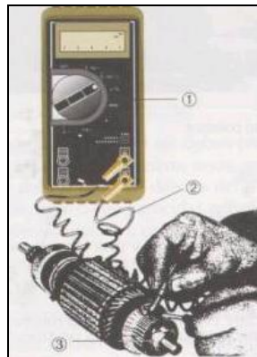
Figura 4.18 Prueba de cortocircuito.
