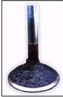
Figura 2.21 Válvula con carbonilla.
