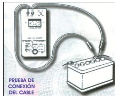
Figura 4.8 Caída de voltaje.
