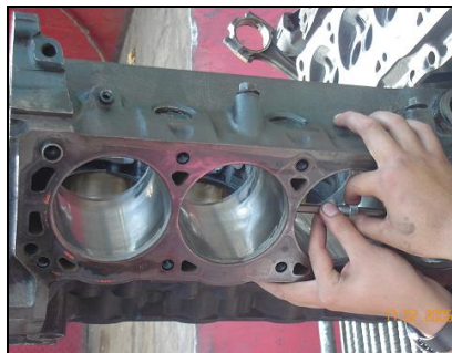
Figura 2.25 Medición de cilindros.
