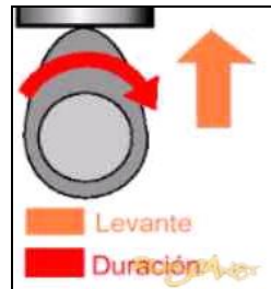
Figura. 2.35 Características de una leva
