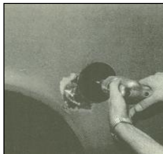
Fig. 6.3 Esmerilado de la pintura.
