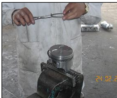
Figura 2.54 Ubicación de anillos en el pistón.
