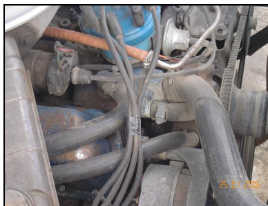
Figura 1.5 Cables, bobina y distribuidor.
