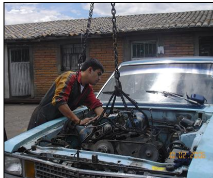
Figura 2.2 Desmontaje del motor.
