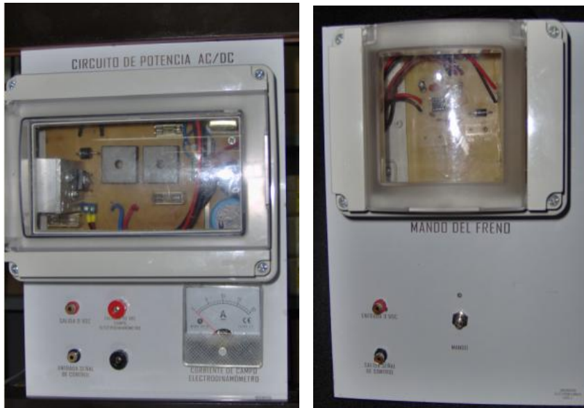
Figura 3.20: Tarjetas electrónicas de control y potencia
