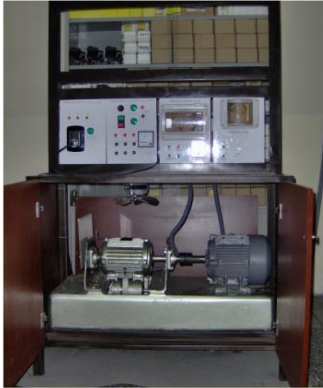
Figura 3.18: Sistema de entrenamiento para motores de 3hp
