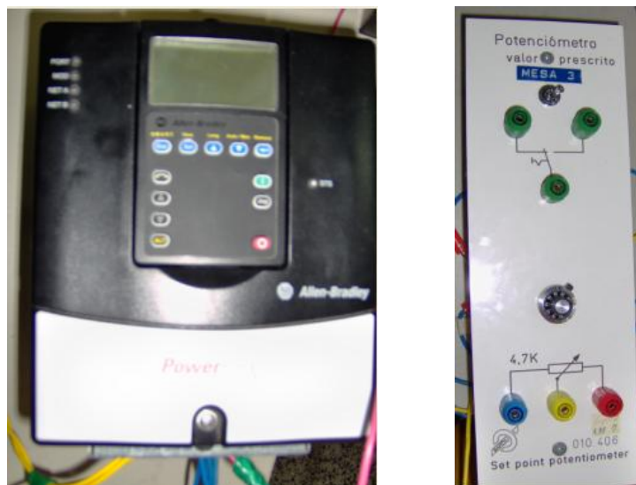
Figura 4.7: Potenciómetro para control remoto de Power Flex 70
