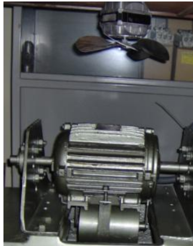
Figura 4.5: Montaje de ventilador enfriador
