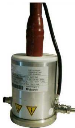
Figura 3.27. Acoplador Capacitivo CMC12 5N0.
