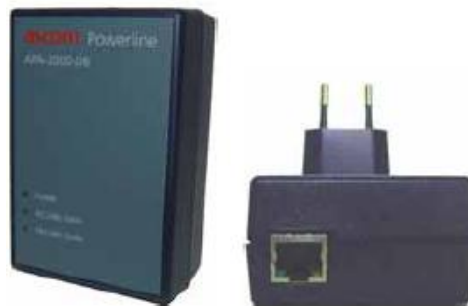
Figura 3.28. Adaptador APA-2000-DB Low Voltaje Data.
