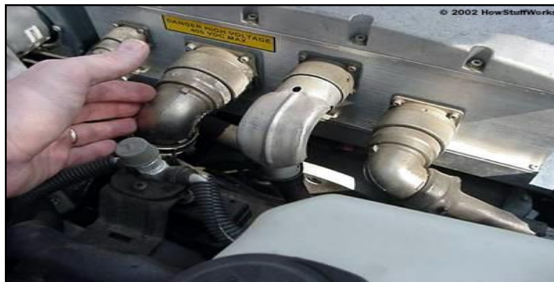
Figura 1.25: Cables gruesos que se conectan al controlador
