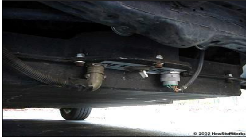
Figura 1.24: Conexión de interruptor
