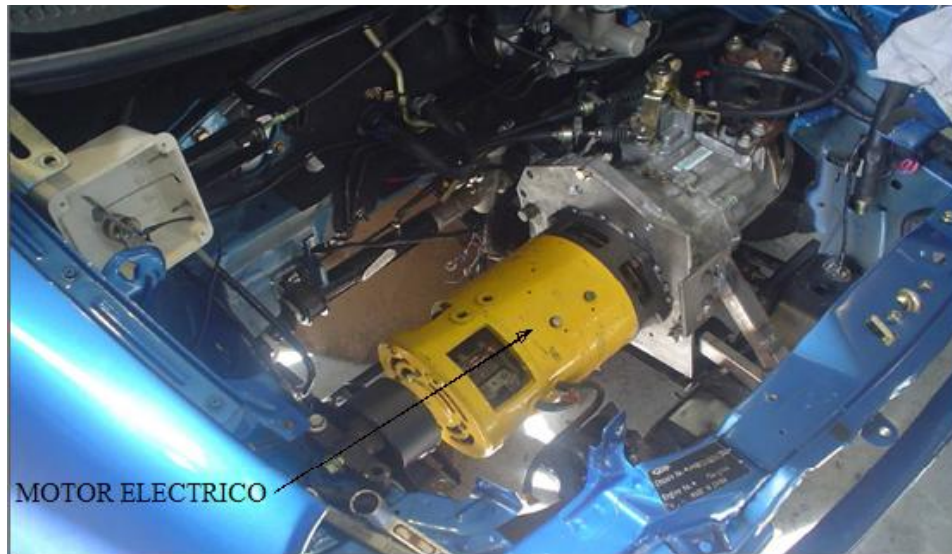
Figura 1.9: Motor eléctrico en el modelo seleccionado un Ckery QQ. 1100 cc. 16 válvulas con dirección hidráulica y aire acondicionado
