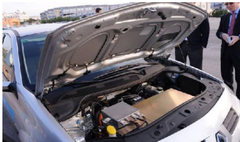
Figura 1.28: Ubicación del Controlador en el vehículo
