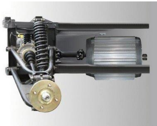
Figura 3.1: Propulsión eléctrica adaptado a un sistema de tracción convencional
