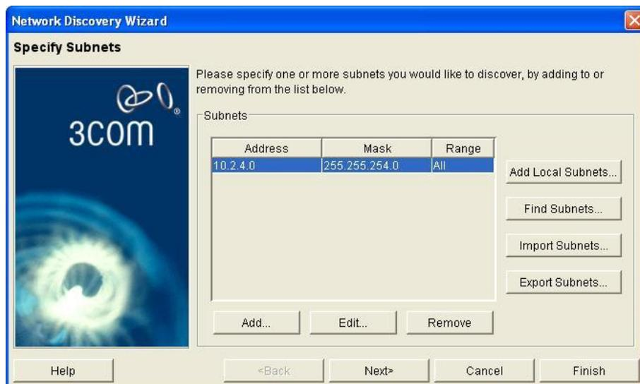
En esta pantalla se ingresa la red que desea descubrir, en este caso la dirección IP de la subred 10.2.4.0 que pertenece a la ESPE-L, continuando con la configuración del proceso de descubrimiento de red, debe confirmar algunas opciones como: protocolo de conexión, existencia de dispositivos telefónicos, etc.
