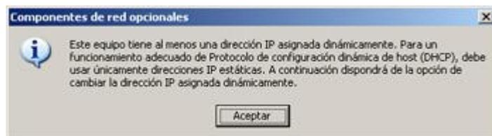
Figura N° 27 (Mensaje para configurar una IP fija)
