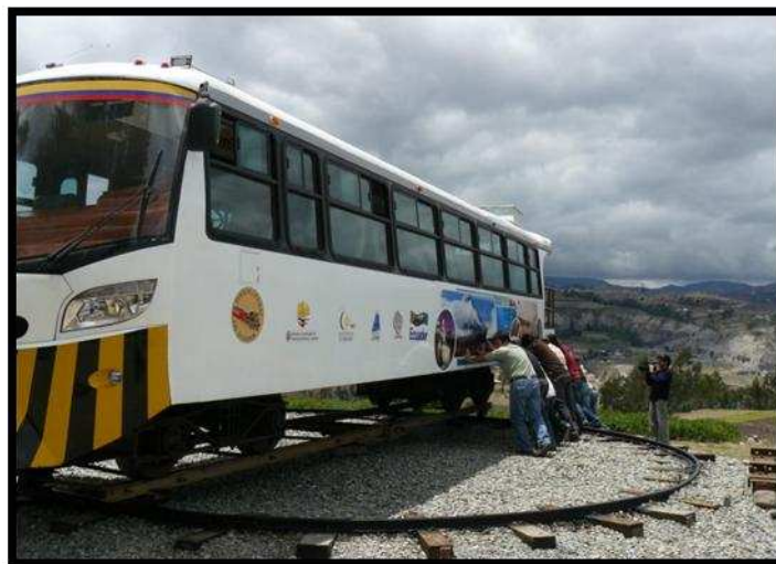
Figura 1.15. Autoferro de la EFE girando en una tornamesa.
