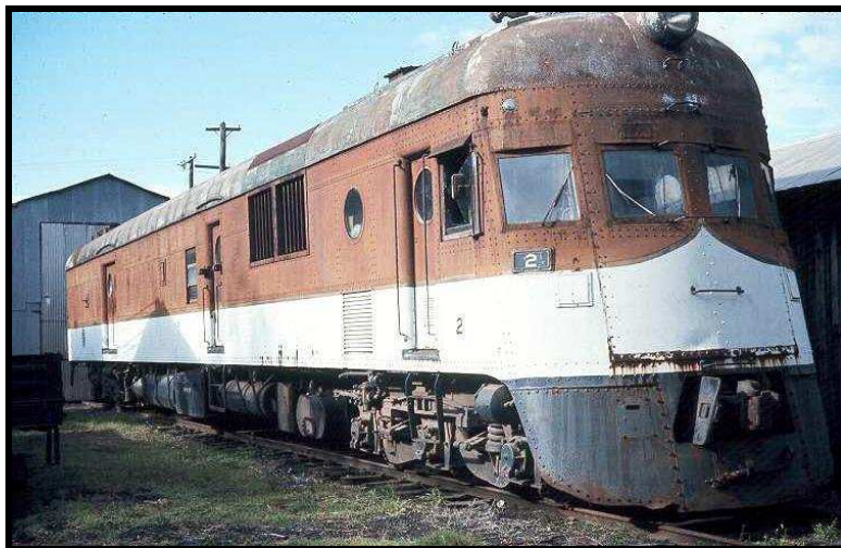
Figura 2.19. Locomotora FM OP800 ejemplo de arreglo A1A-2.
