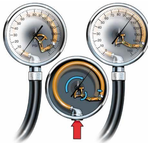
Figura 4. 13 Funcionamiento de manómetro tipo Tubo Bourdon
