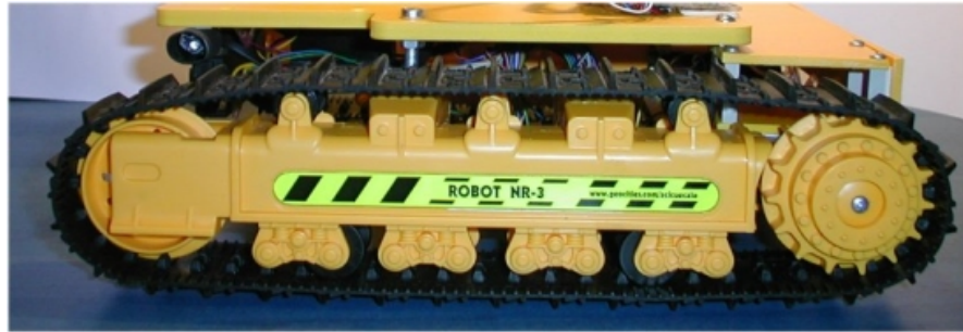
Figura. 3.4. Locomoción tipo Oruga
