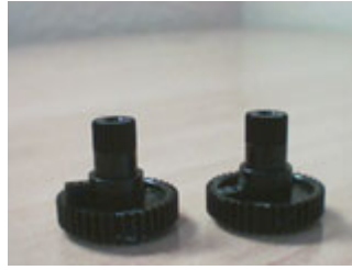
Figura. 2.10. Corte del tope mecánico del Servomotor
