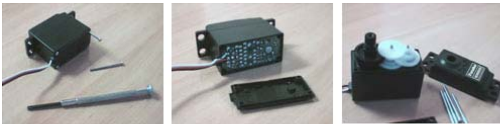
Figura. 2.8. Desmontaje de la Tapa del Servomotor
