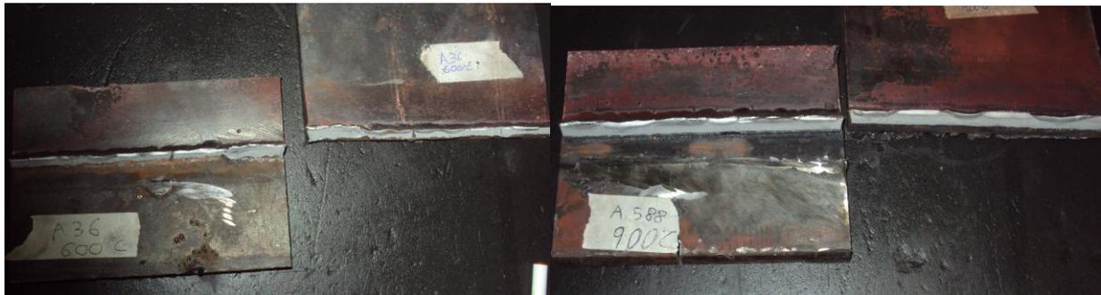
Rotura en probetas de acero A36
