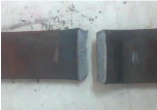
Acero A 588 y Electrodo E 81T1-Ni 1 a 300°C
