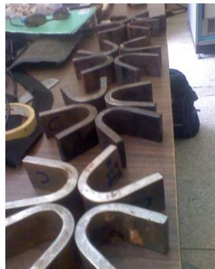
Probetas de acero A 36 y Electrodo E 71T 1
